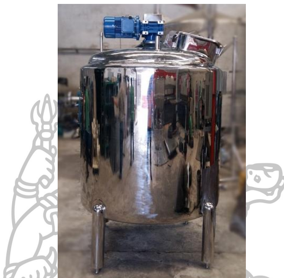
รูปที่ 3.2 ถังผสม (Mixing Tank)
