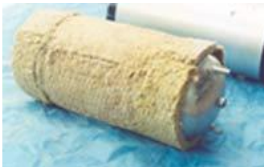
รูปที่ 2.10 ถังเก็บน้ำร้อนของเครื่องทำน้ำร้อนพลังงานแสงอาทิตย์ [7]
