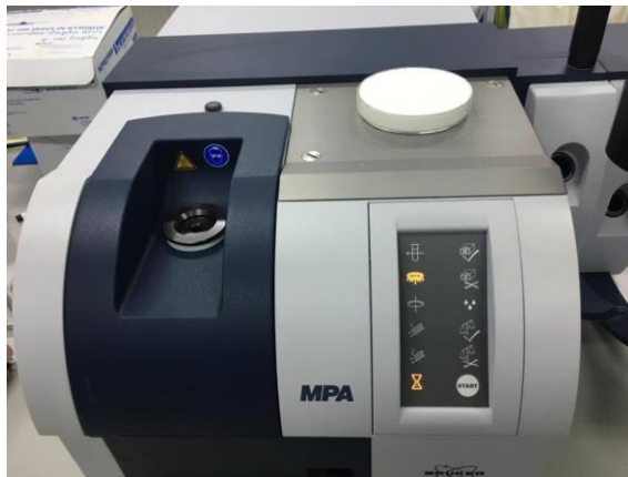
ภาพที่ 15 การวัดสเปกตรัมตัวอย่างคอลลอยด์ด้วยระบบสะท้อนกลับ
