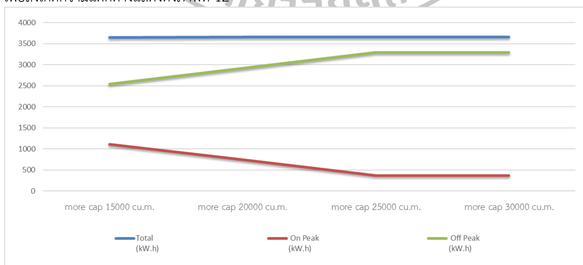
ภาพที่ 14 กำลังงานไฟฟ้าจากกำหนดเชิงเส้น โดยปรับเปลี่ยนปริมาณถังน้ำใส
