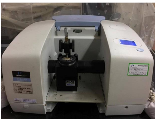
รูปที่ 3.7 การวิเคราะห์ด้วยเทคนิค ATR-FTIR
