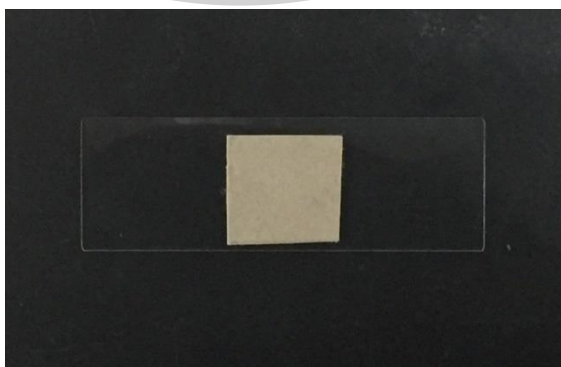
รูปที่ 3.8 การวิเคราะห์ด้วยเทคนิค XRD ตัวอย่างกระดาษวางเป็นแผ่นให้ผิวหน้าของตัวอย่างเรียบสม่ำเสมอ
