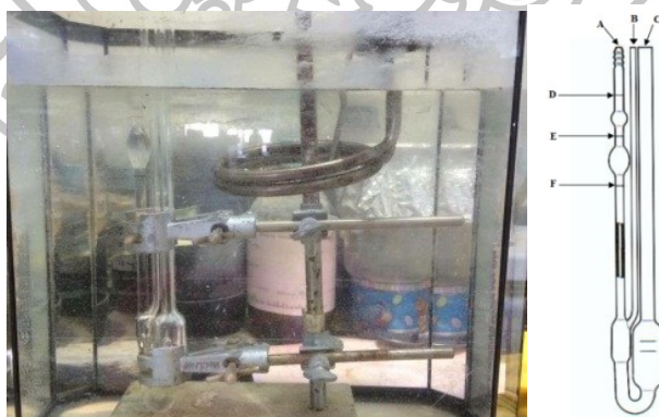
ภาพที่ 3.6 แสดงการจัดเครื่องมือและตำแหน่งต่างๆ ในการทดลองวัดค่าความหนืดโดยใช้ viscometer
