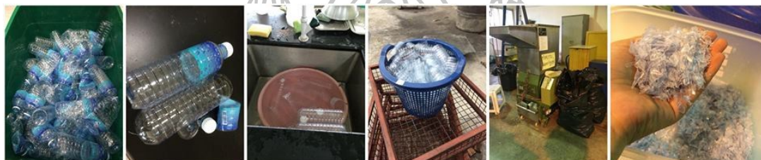
ภาพที่ 3.1 แสดงกระบวนการเตรียม Flake recycled PET
