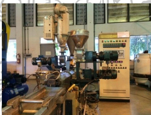
ภาพที่ 3.2 ขั้นตอนการหลอมผสมด้วยเครื่องอัดรีดแบบสกรูคู่
