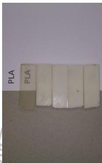
ภาพภาคผนวกที่ ก- 1แสดงลักษณะทางการภาพของพอลิเมอร์เบลนด์ระหว่าง PLA กับ ABS powder ปริมาณ 5 phr, 10 phr ,15 phr และ 20 phr
