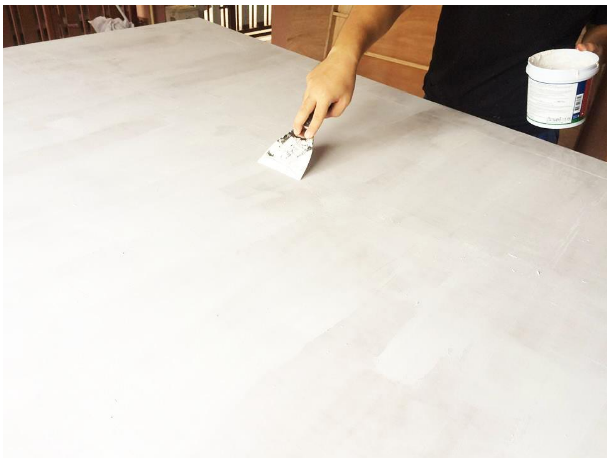
ภาพที่ 5 ภาพขั้นตอนการเตรียมพื้นผิวงานบนเฟรมไม้กระดาน
