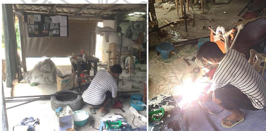
ภาพที่ 15 การวัดขนาดเส้นเหล็กและการเชื่อมประกอบเพื่อขึ้น โครงสร้างวิทยานิพนธ์ ชั้นที่ 2
