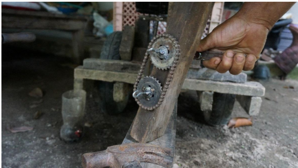
ภาพที่ 16 ภาพเครื่องมือขับเคลื่อนจากเฟืองมอเตอร์ไซค์
