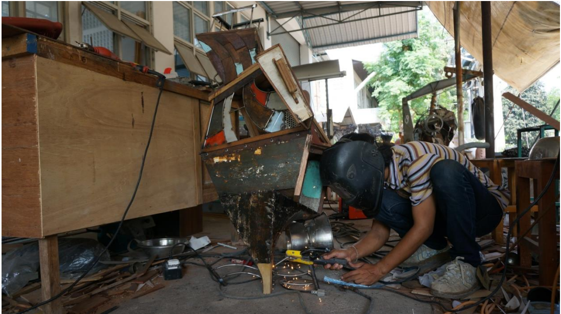
ภาพที่ 41 ภาพกระบวนการเชื่อมเหล็ก
