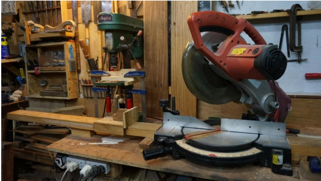
ภาพที่ 49 ภาพอุปกรณ์: เลื่อยตัดองศา แทนเจอะ
