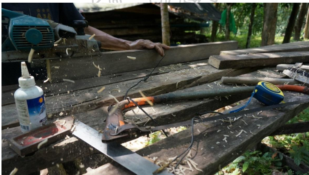
ภาพที่ 15 ภาพกำลังไสไม้ด้วยกบไฟฟ้า
