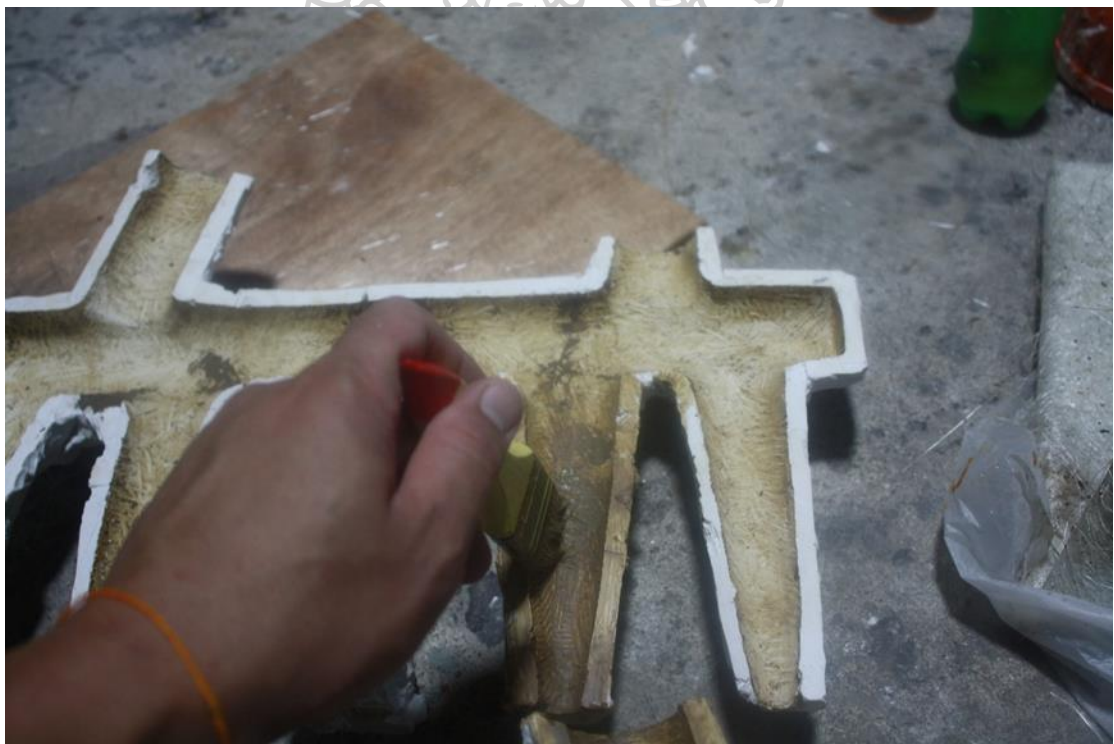
ภาพที่ 34 การทากั้นแม่พิมพ์ด้วยน้ำดิน(น้ำ slip)
