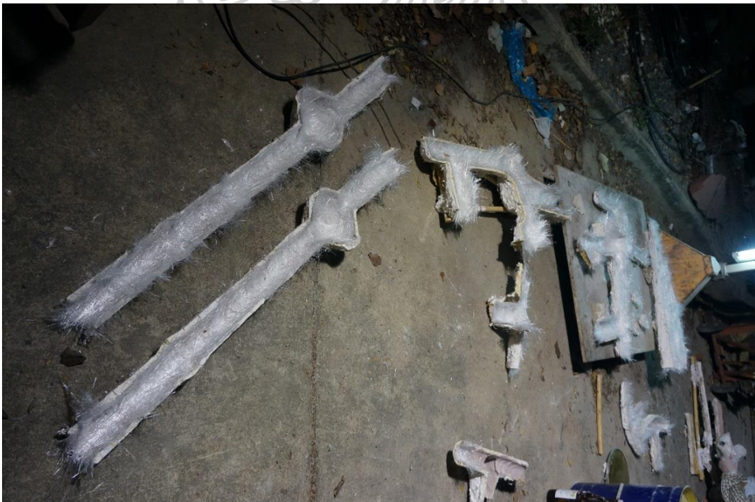
ภาพที่ 21 ภาพตัวอย่างการหล่อด้วยเรซิน
