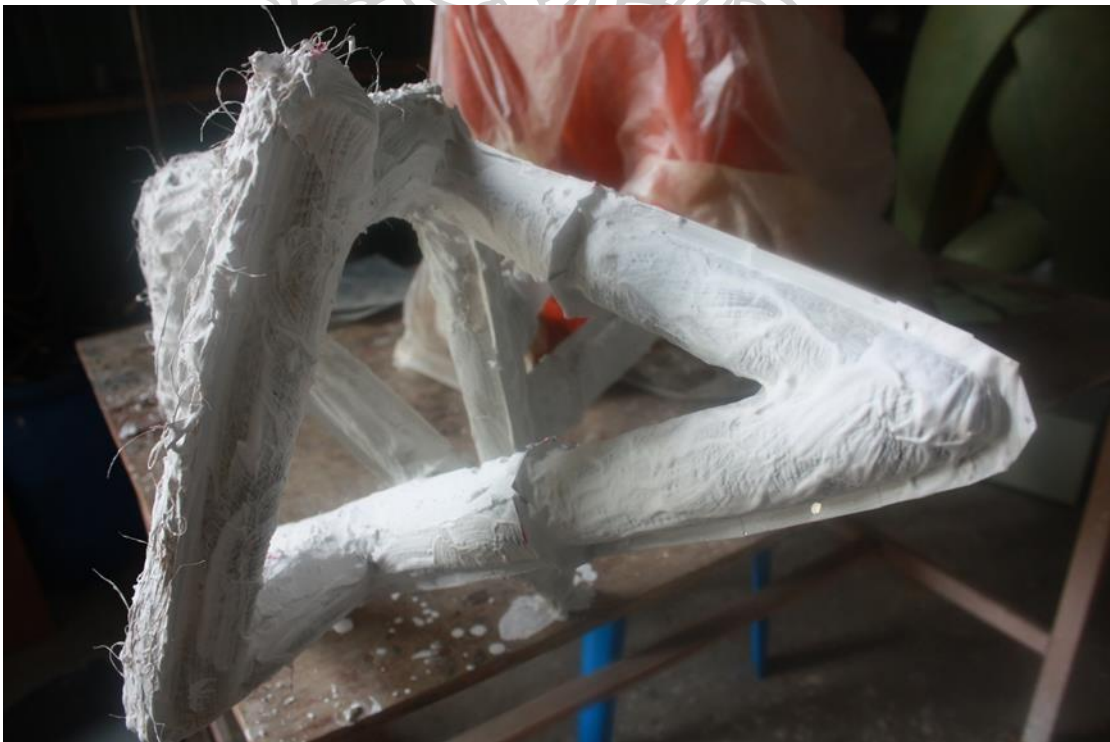
ภาพที่ 31 การทำพิมพ์ชิ้นแรกด้วยปูนปลาสเตอร์
