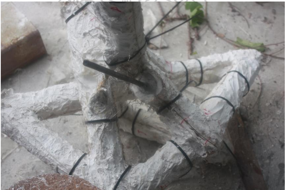
ภาพที่ 38 ขั้นตอนการประกบแม่พิมพ์เข้าหากัน
