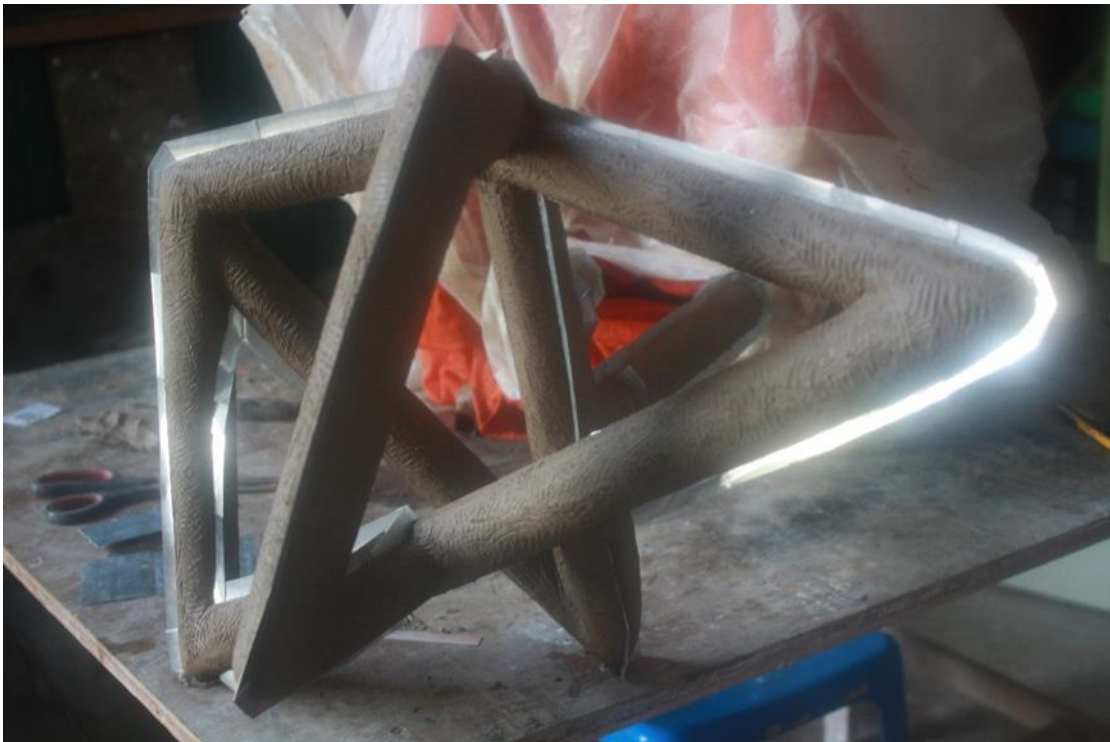
ภาพที่ 30 การกั้นแบ่งแม่พิมพ์ด้วยแผ่นอะลูมิเนียม
