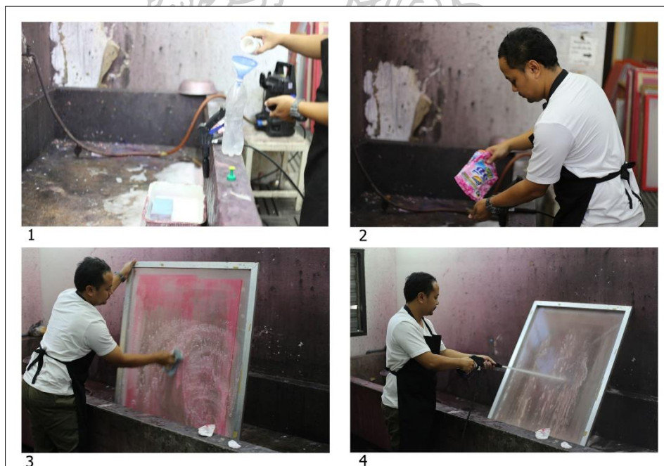
ภาพที่ 25 ภาพแสดงการล้างทำความสะอาดรابعาวัดบนบล็อกลูกสกรีน
