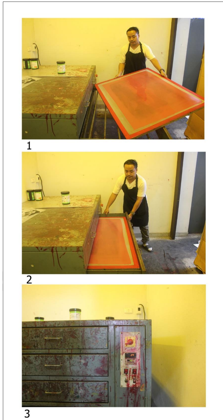
ภาพที่ 21 ภาพแสดงการ อบบล็อกสกรีนในตู้อบความร้อน
