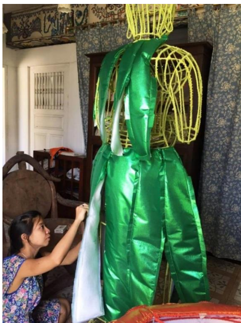
ภาพที่ 67 ภาพแสดงขั้นตอนการใช้วิธีการทำ pattern จากผ้าซ้อนทับโครงสร้างเหล็ก เพื่อประกอบสร้างเป็นรูปทรงหลัก ( form )
