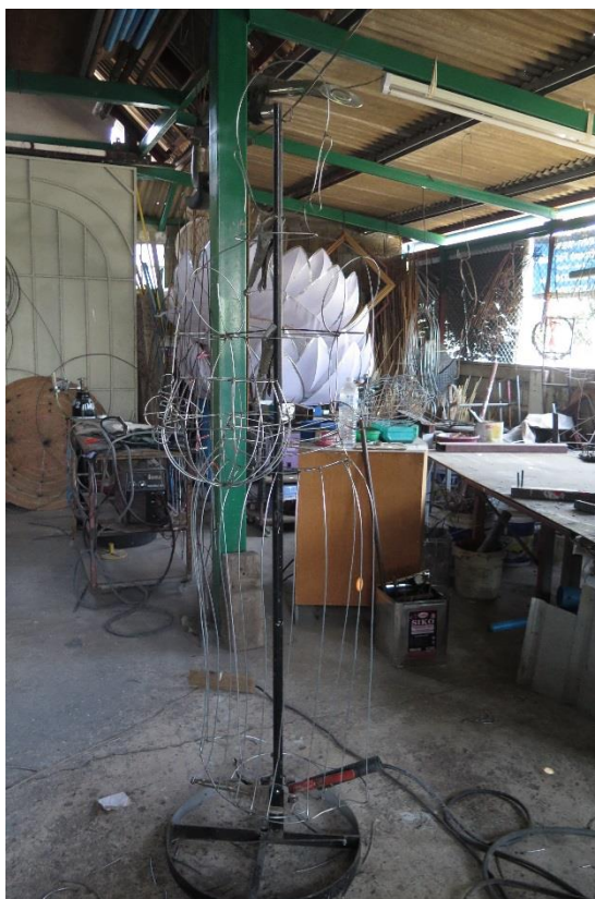
ภาพที่ 65 ภาพแสดงขั้นตอนการขึ้น โครงเหล็กเป็นชิ้นงานสามมิติ
