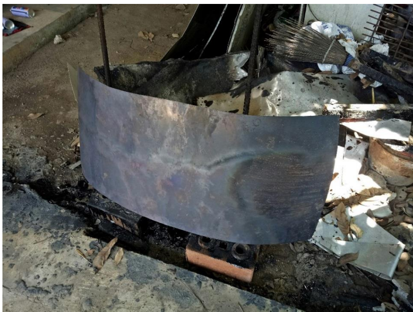
ภาพที่ 198 เเผาแผ่นวัสดุที่เราจะใช้ด้วยความร้อน เพื่อให้แผ่นโลหะเกิดความยืดหยุ่นขึ้นทรงรูปได้ง่าย
