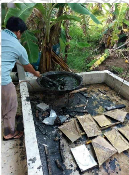
ภาพที่ 207 เมื่อ둔ด้านหลังเสร็จนำไปพับขอบชิ้นงานเพื่อเข้าชั้น ในการเคียวชั้นคือต้มให้ละลายแล้ว
