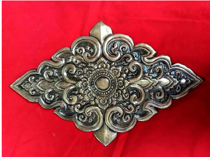
ภาพที่ 218 นำชิ้นงานมาตกแต่งและตะไบลบคม และทำสีตามที่เราต้องการ
