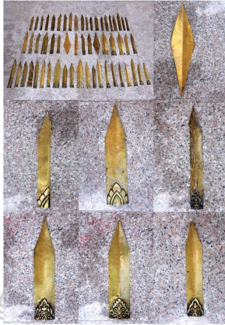
ภาพที่ 220 ภาพแผ่นโลหะที่ดุนนูนเสร็จเรียบร้อยแล้ว เพื่อเตรียมมาประกอบกับพระวิมาน
