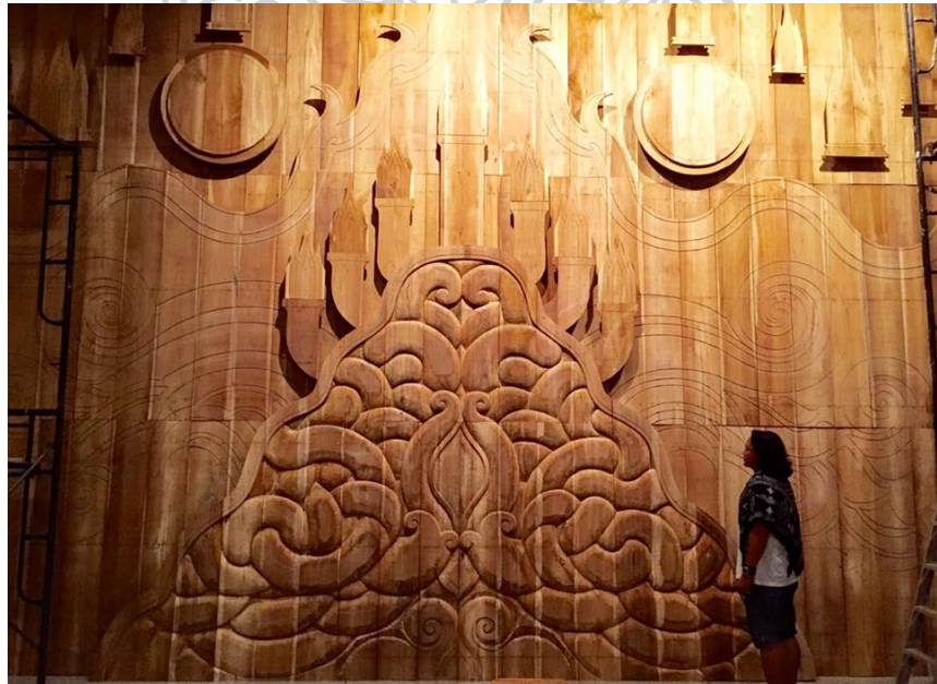
ภาพที่ 133 ทดลองแกะแผ่นไม้ที่ประกบเพิ่มเข้าไป 3 ชั้น เพื่อให้เกิดปริมาตรตามต้องการ
