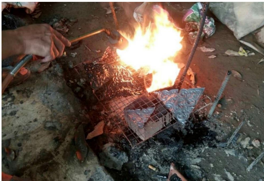
ภาพที่ 214 เผาชิ้นงานอีกรอบให้ชิ้นใหม่ออกหมดจากชิ้นงาน
