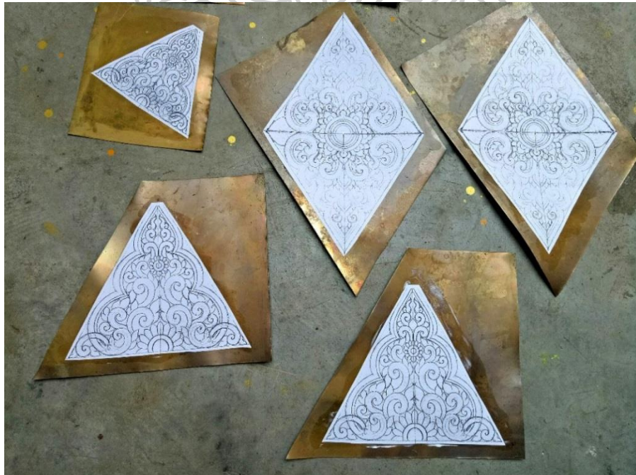
ภาพที่ 200 นำแผ่นวัสดุที่เผาและรอให้เย็นแล้ว จากนั้นนำแบบที่สเก็ตไว้มาติดบนแผ่นโลหะที่เราต้องการใช้งาน
