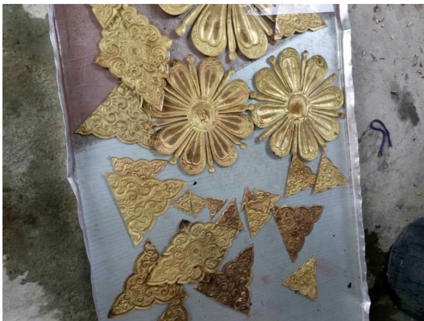
ภาพที่ 216 นำมาล้างด้วยน้ำยาล้างจานอีก 1 รอบเพื่อให้ชิ้นงานสะอาดที่สุด เพราะถ้าชิ้นงานไม่สะอาด
