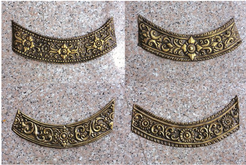
ภาพที่ 222 ภาพแผ่นโลหะที่คูนนูนเสร็จเรียบร้อยแล้ว เตรียมติดตั้งประกอบกับลำตัวของพญานาคบน
