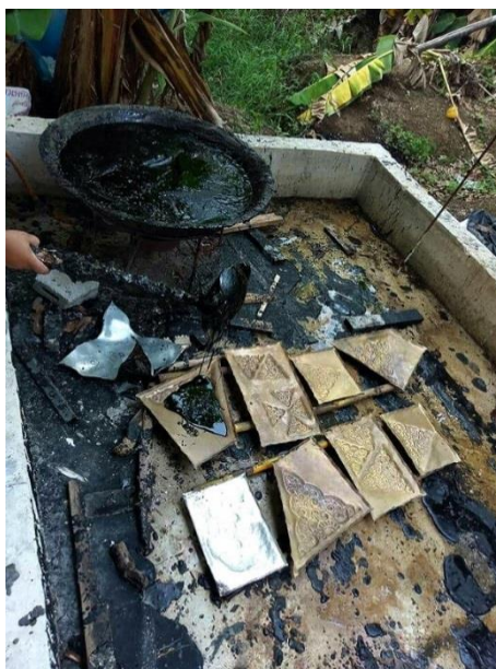
ภาพที่ 206 เมื่อ둔ด้านหลังเสร็จนำไปพับขอบชิ้นงานเพื่อเข้าชั้น ในการเคียวชั้นคือต้มให้ละลายแล้วตักเทใส่ชิ้นงานให้เต็มแผ่นหลัง
