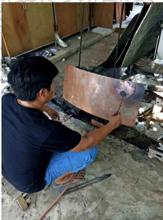
ภาพที่ 199 เเผาแผ่นวัสดุที่เราจะใช้ด้วยความร้อน เพื่อให้แผ่นโลหะเกิดความยืดหยุ่นขึ้นทรงรูปได้ง่าย
