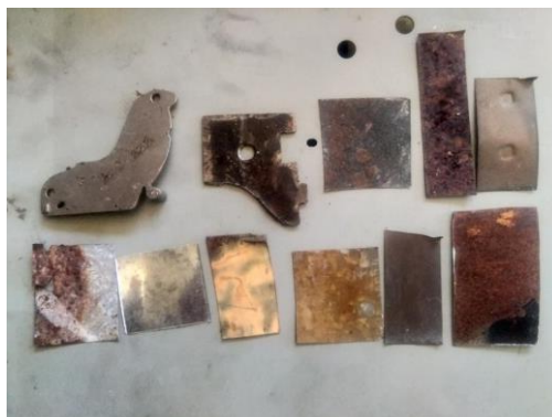
ภาพที่ 10 ภาพการเปรียบเทียบสีและพื้นผิวของ โลหะวัสดุ และการกัดสนิม โดยความเข้มข้นกรดที่ต่างกัน
