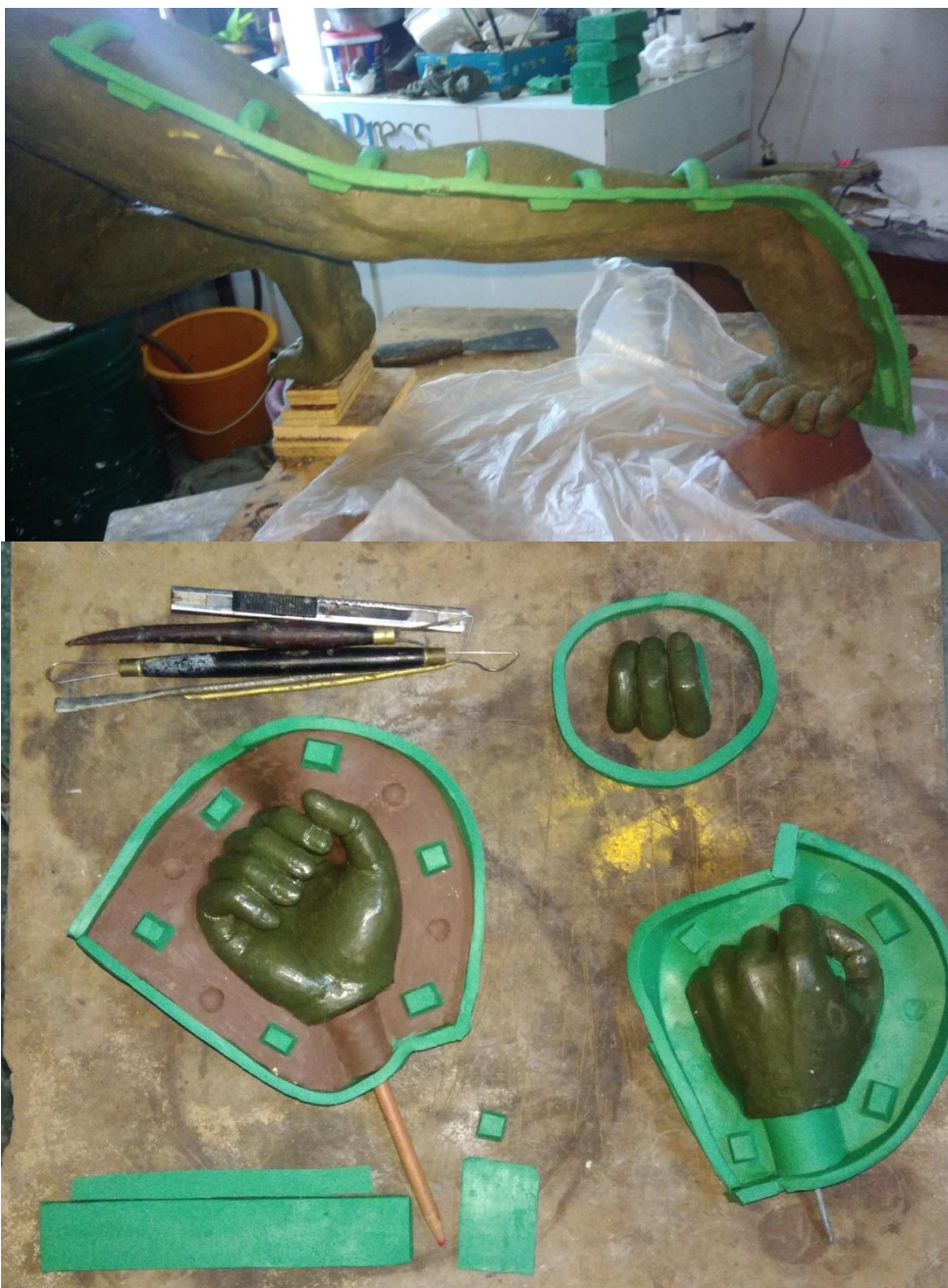
ภาพที่ 34 ใช้ดินน้ำมันกั้นแบ่งเพื่อเตรียมทำพิมพ์ยางซิลิโคน นำดินมากลึงแล้วรีดให้แบนเสมอกันตัดความกว้างให้ได้ขนาด 1 นิ้ว นำมากั้นเก็บตะเข็บ รอยร้าวด้านแรกทำท่อส่งของเหลวในการเทหล่อเรซิน เรียบร้อยแล้วทำขอบกั้นการไหลออกของน้ำ ยาง และวางตัวล๊อคกันพิมพ์เคลื่อน
