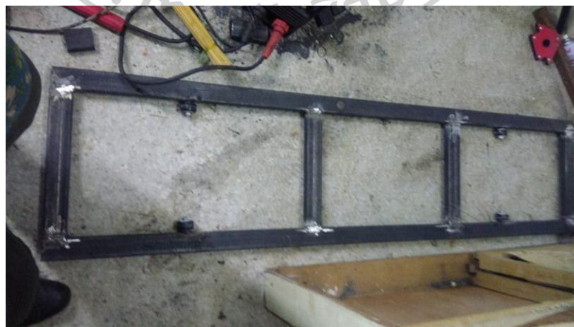
ภาพที่ 40 การเชื่อมประกอบโครงสร้างภายในฐานตั้งชิ้นงาน
