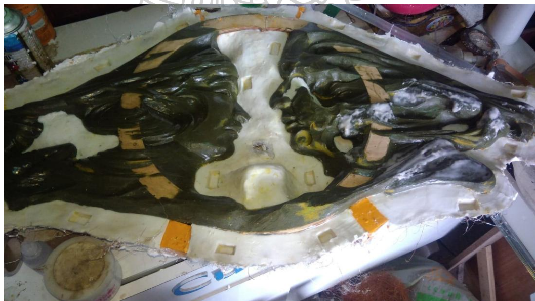
ภาพที่ 44 การเทยางซิลิโคนลงบนพิมพ์หน้า 2
