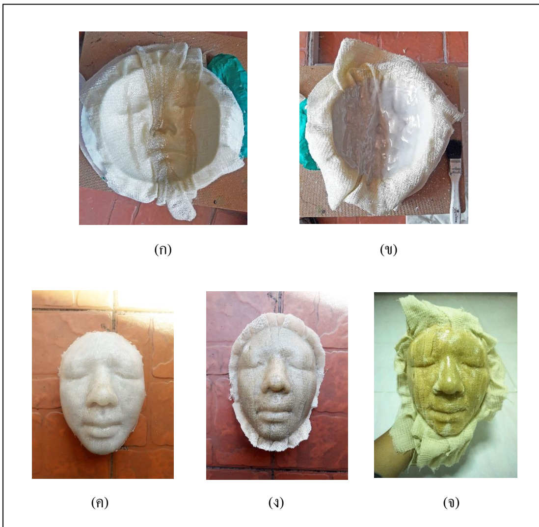
ภาพที่ 19 ขั้นตอนการหล่อเรซิน
