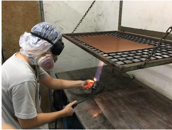
ภาพที่ 22 การย่างผงแอสฟัลต์บนแม่พิมพ์
