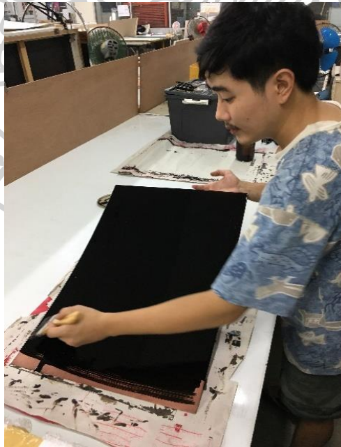
ภาพที่ 19 การเคลือบแม่พิมพ์ด้วยวานิชดำ
