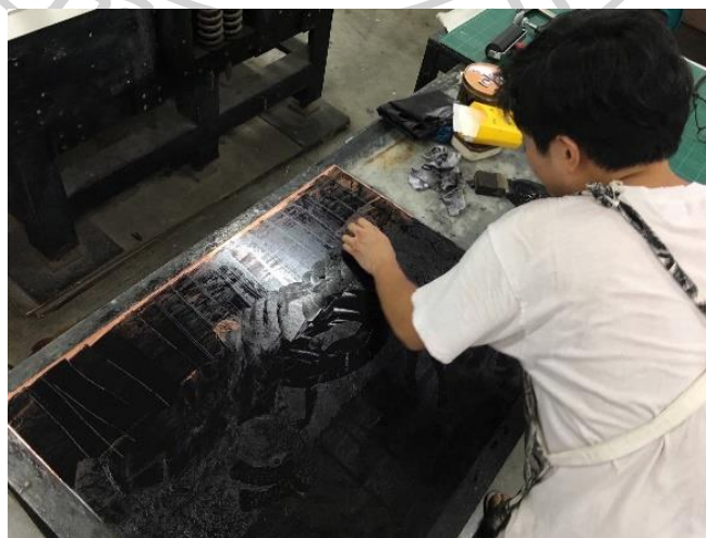
ภาพที่ 29 การอุดหมึกแม่พิมพ์ร่องลึก
