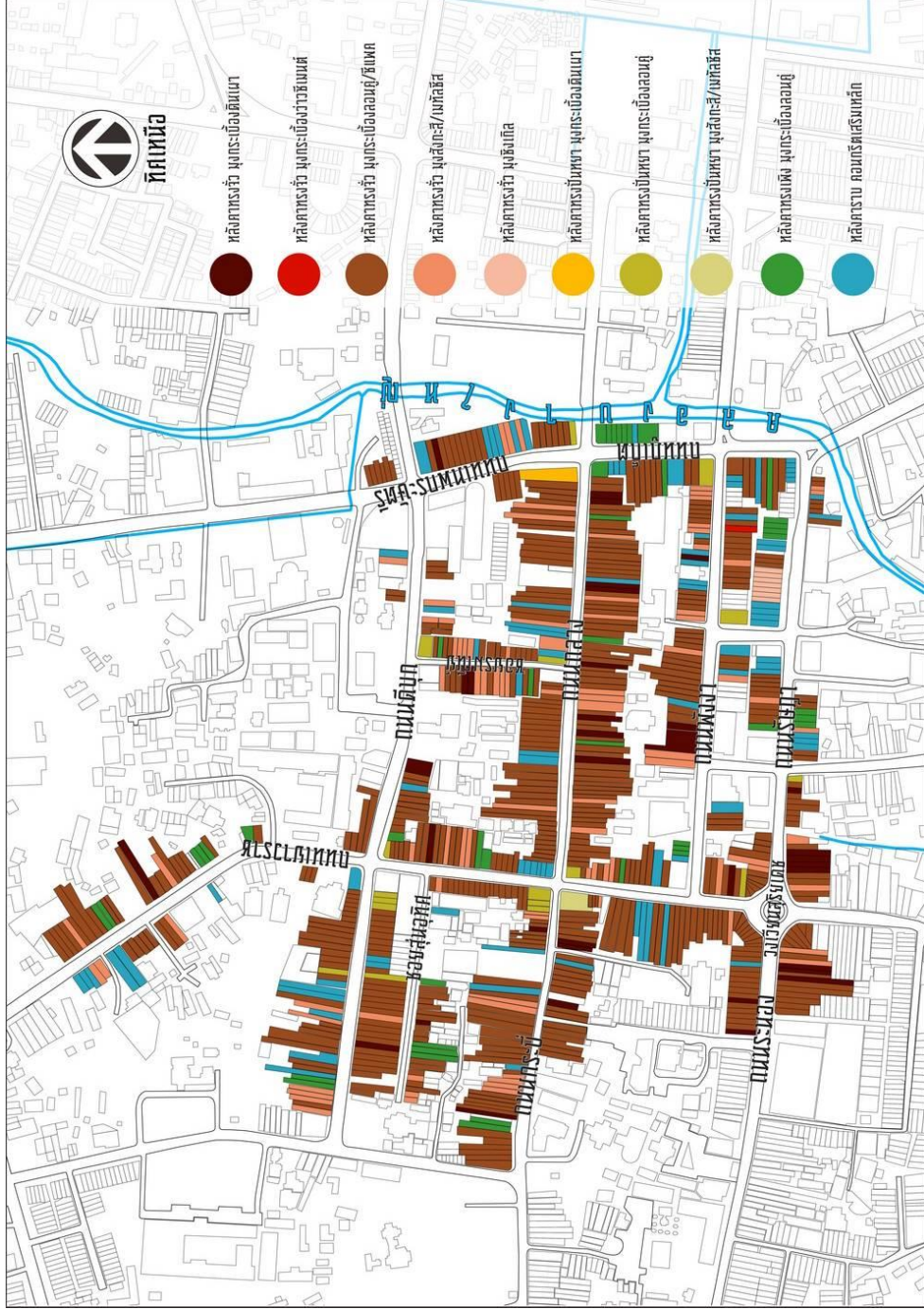
ภาพที่ 32: แผนผังแสดงรูปแบบหลังคาและประเภทของวัสดุมุงตึกแถวย่านปราชญ์ศึกศาสตร์เมืองเก่า
