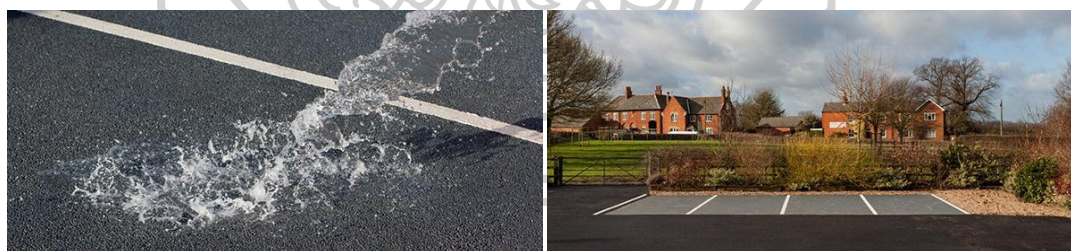
ภาพที่ 14 ภาพซ้ายแสดงตัวอย่างการทดสอบน้ำที่ซึมผ่านคอนกรีตภาพขวาคือตัวอย่างก่อสร้างแล้ว
