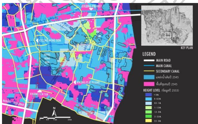
ภาพที่ 42 แผนที่วิเคราะห์ระดับพื้นที่เขตประเวศกับชั้นข้อมูลพื้นที่ชุมชน แหล่งน้ำปี พ.ศ.2545 ที่มา: (กรมแผนที่ทหาร, 2553) ดัดแปลงจากแผนที่แสดงแนวคันกันน้ำและระดับพื้นที่ในเขต กรุงเทพมหานครและปริมณฑล, 2553.
