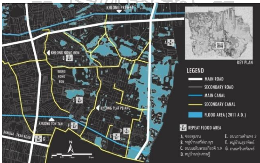
ภาพที่ 44 แผนที่แสดงบริเวณน้ำท่วมและจุดอ่อนน้ำท่วม เขตประเวศ ที่มา: (สำนักการระบายน้ำกรุงเทพมหานคร, 2559) และ (กรมทางหลวงชนบท, 2554)
