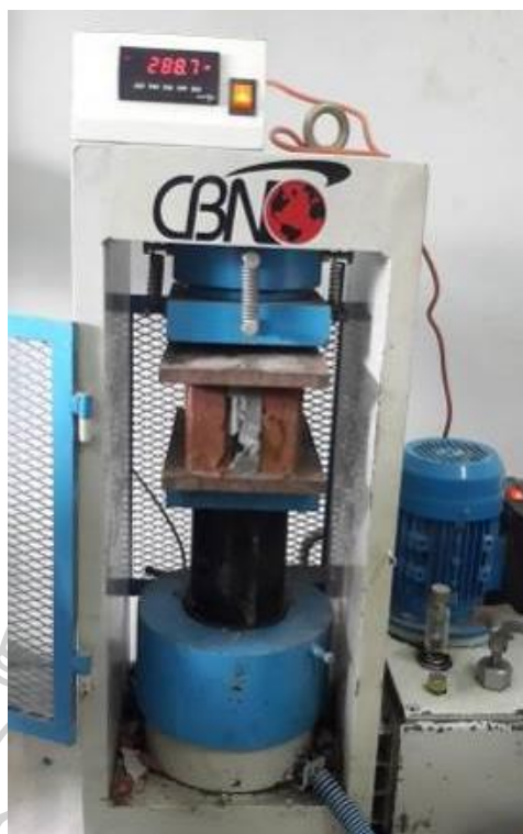
ภาพที่ 50 แสดงภาพขั้นตอนการทดสอบกำลังแรงอัดจนได้ค่ากำลังแรงอัดสูงสุด
