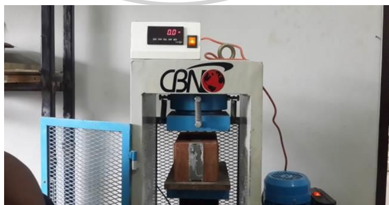
ภาพที่ 49 แสดงภาพขั้นตอนการนำก้อนวัสดุบล็อกประสานเข้าเครื่องทดสอบกำลังแรงอัด
