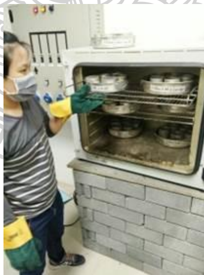
ภาพที่ 26 แสดงภาพขั้นตอนการทดสอบเข้าตู้อบที่อุณหภูมิ 105 องศาเซลเซียส
