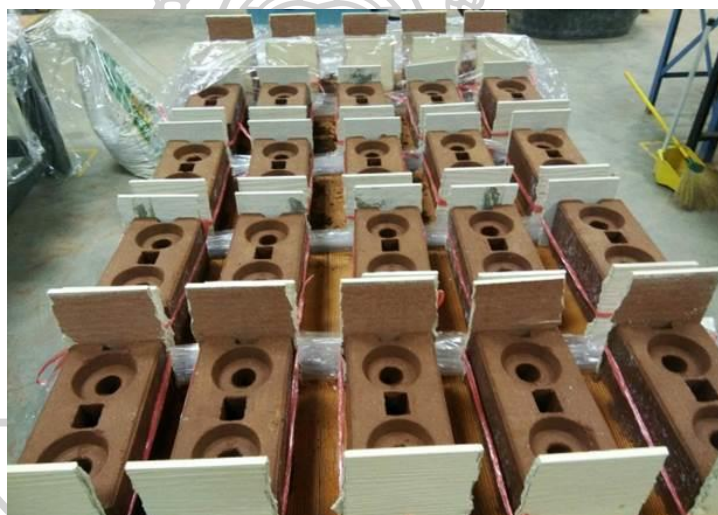
ภาพที่ 36 แสดงภาพขั้นตอนนำบล็อกประสานคว่ำหน้าลง ติดตั้งไม้แบบยึดกับตัวบล็อกประสาน
