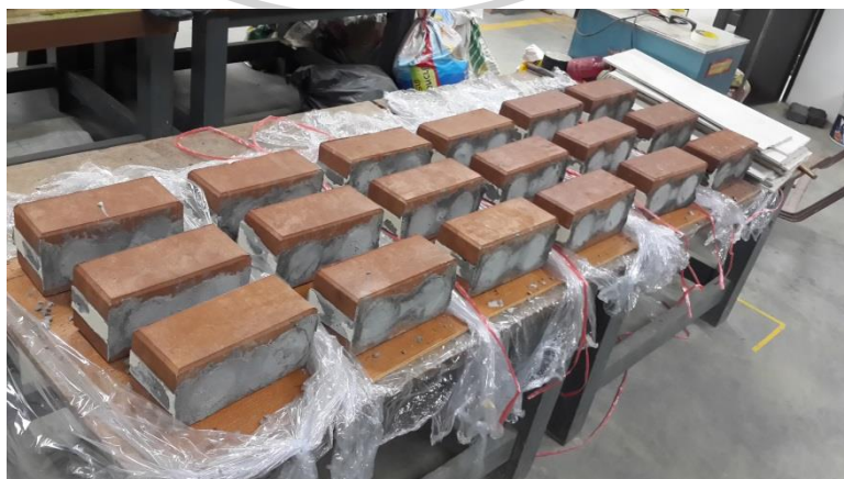
ภาพที่ 46 แสดงภาพขั้นตอนการตรวจสอบบล็อกประสานเมื่อครบกำหนดอายุบ่ม
