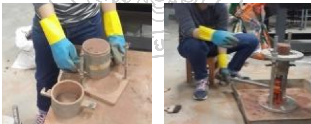
ภาพที่ 24 แสดงภาพขั้นตอนการเข้าเครื่องดินแม่แรง เพื่อเก็บตัวอย่างทดสอบ
