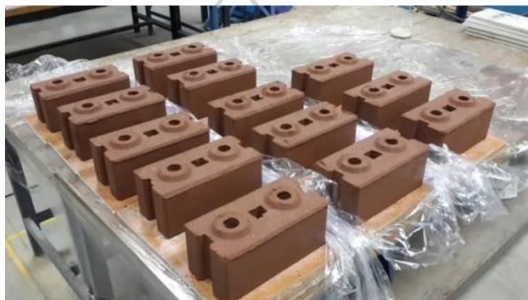
ภาพที่ 34 แสดงภาพขั้นตอนนำบล็อกประสานวางเรียงบนผ้าพลาสติก
