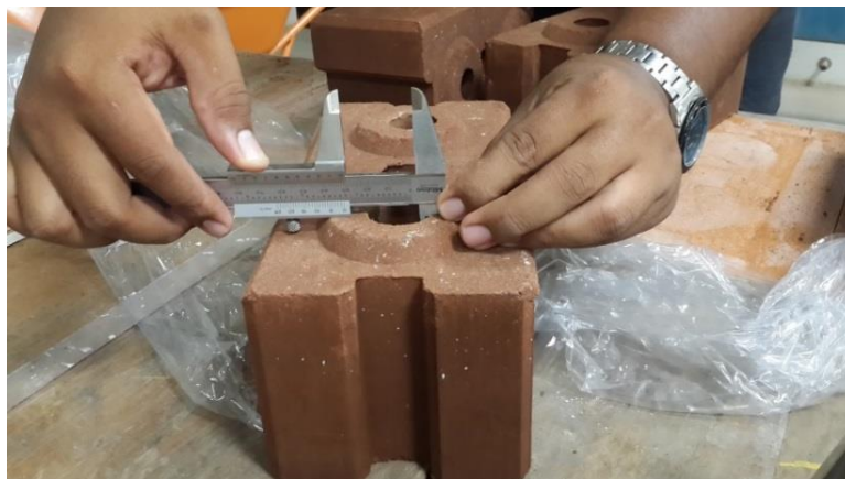
ภาพที่ 69 แสดงภาพขั้นตอนการนำบล็อกประสานมาวัดขนาด
