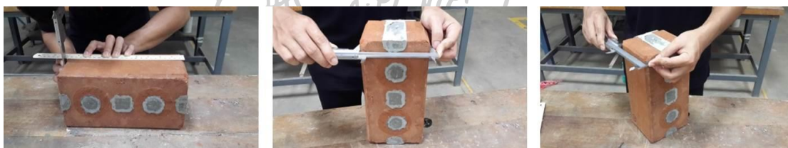
ภาพที่ 48 แสดงภาพขั้นตอนการวัดขนาดก้อนด้วยเครื่องมือวัดเวอร์เนีย
