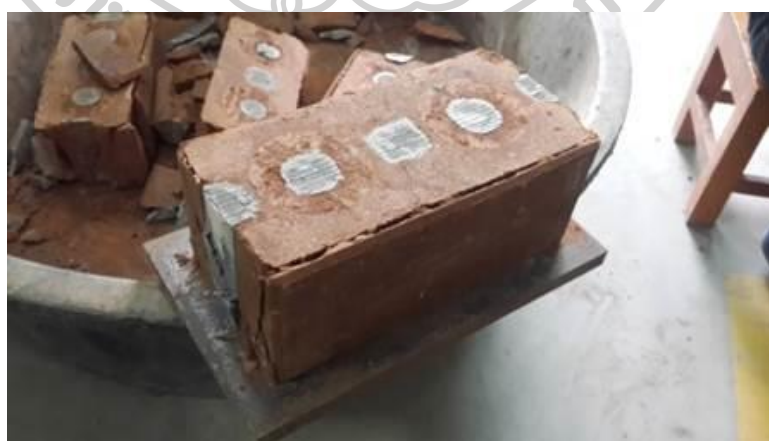
ภาพที่ 51 แสดงภาพขั้นตอนการนำก้อนวัสดุบล็อกประสานออกจากเครื่องทดสอบกำลังแรงอัด
