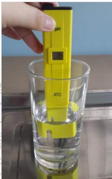
ภาพที่ 17 แสดงภาพทดสอบวัดค่ากรด – ด่าง (pH) ในน้ำประปาสะอาด
