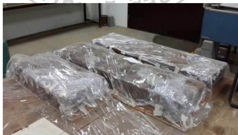
ภาพที่ 35 แสดงภาพขั้นตอนใช้พลาสติกคลุมบล็อกประสาน แล้วทิ้งไว้จนครบอายุบ่มที่กำหนด
