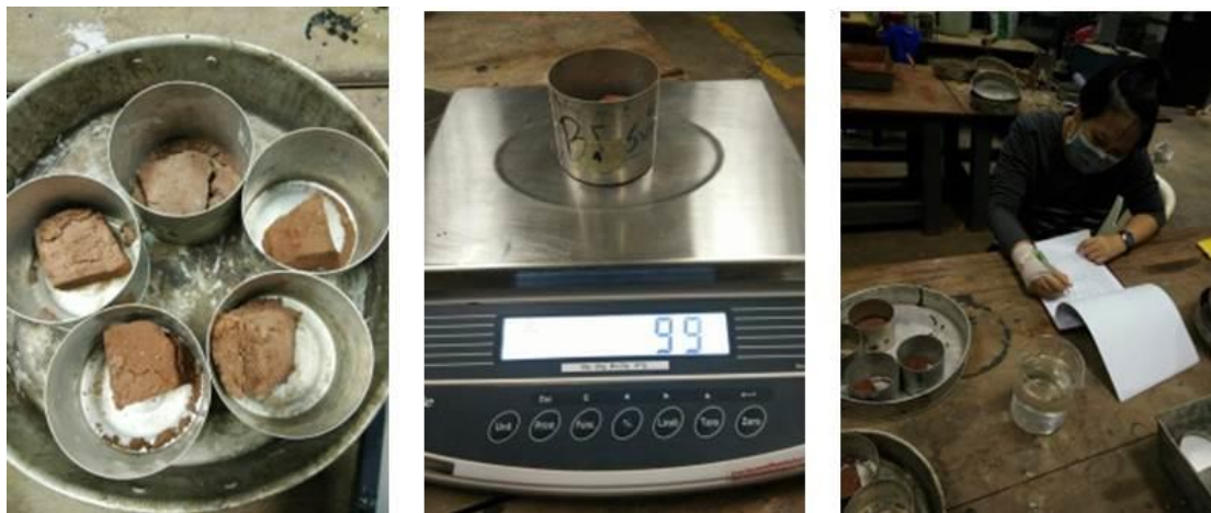
ภาพที่ 27 แสดงภาพขั้นตอนบันทึกค่าหลังการทดสอบเข้าตู้อบที่อุณหภูมิ 105 องศาเซลเซียส
