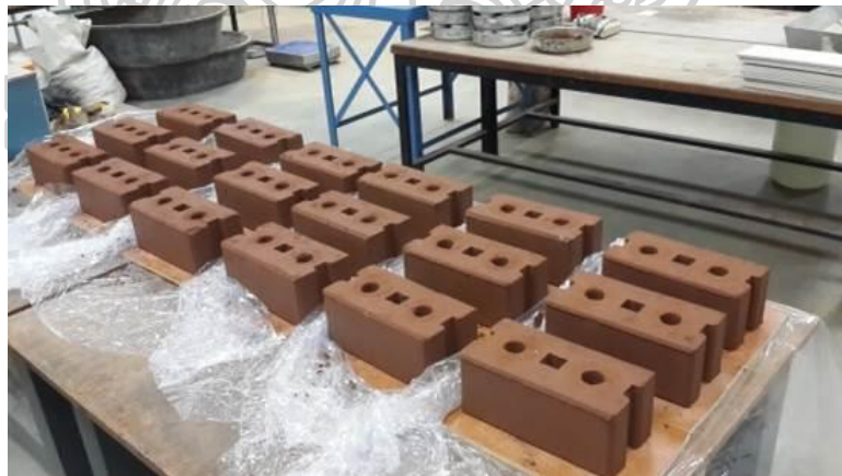
ภาพที่ 33 แสดงภาพขั้นตอนนำบล็อกที่อัดไปวางเรียง รอจนบล็อกเริ่มแข็งตัว แล้วบ่มหลัง 24 ชั่วโมง
