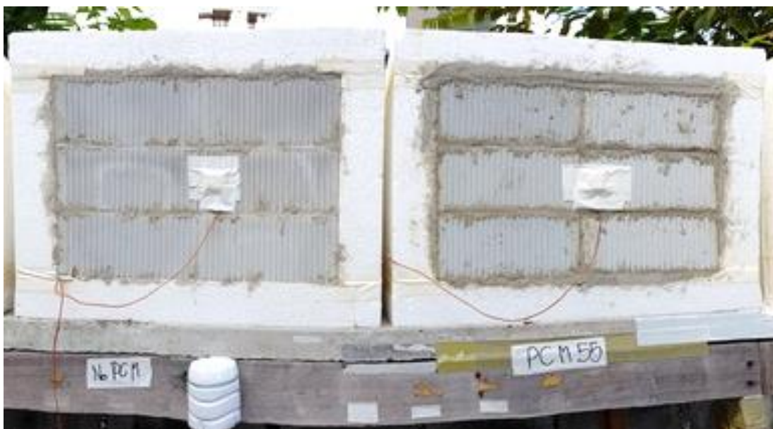
ภาพที่ 49 แสดงกล่องทดลอง ผนังอิฐขาวไม่บรรจุ PCMs และ ผนังอิฐขาวบรรจุ PCM 55 วันที่ทำการทดลอง 8 ตุลาคม – 10 ตุลาคม 2560
