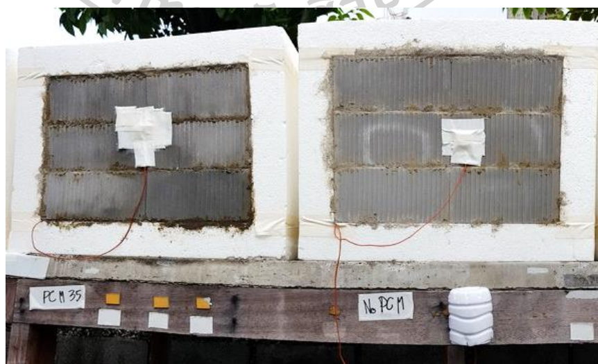
ภาพที่ 39 แสดงกล่องทดลอง ผนังอิฐขาวไม่บรรจุ PCMs และ ผนังอิฐขาวบรรจุ PCM 35 วันที่ทำการทดลอง 30 กันยายน - 2 ตุลาคม 2560
