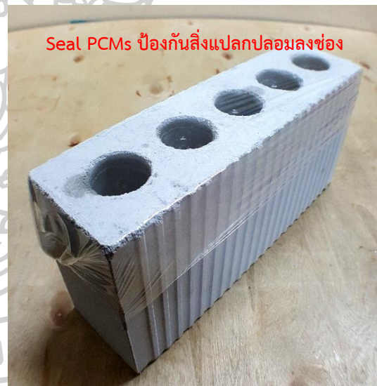
ภาพที่ 16 ปิดผนึกPCMs ช่วงรอแข็งตัวเพื่อ ป้องกันสิ่งแปลกปลอม
