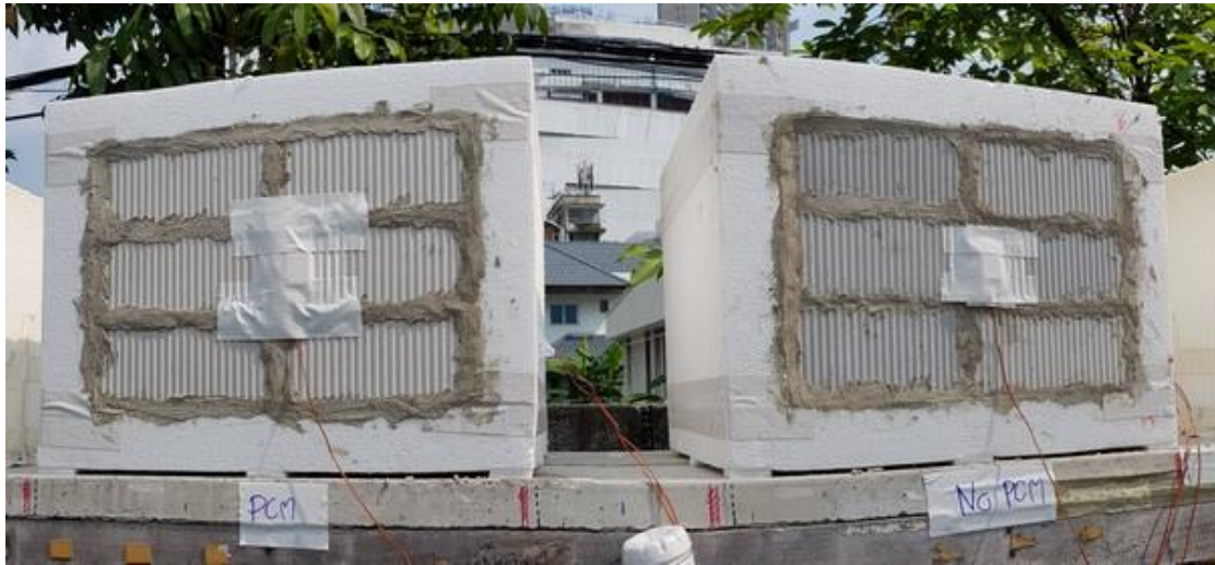
ภาพที่ 56 แสดงกล่องทดลอง ผนังอิฐขาวที่บรรจุ PCM35 และผนังอิฐขาวที่ไม่บรรจุ PCMs วันที่ทำการทดลอง 14-16 มีนาคม 2561
