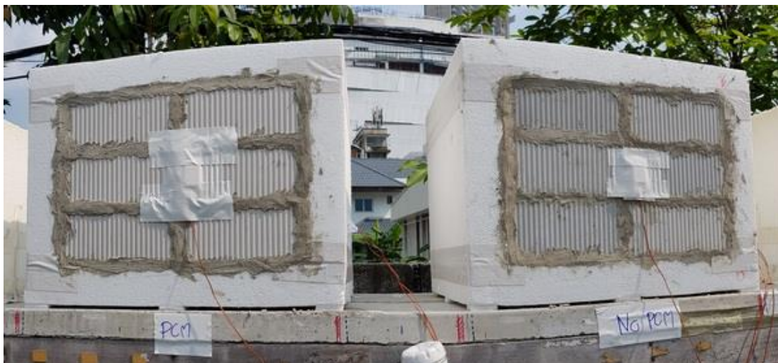
ภาพที่ 38 แสดงกล่องทดลอง ผนังอิฐขาวที่บรรจุ PCM35 และผนังอิฐขาวที่ไม่บรรจุ PCMs วันที่ทำการทดลอง 14-16 มีนาคม 2561
