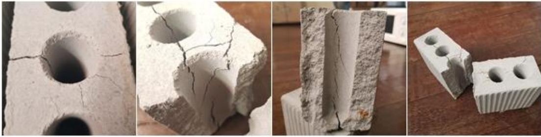
ภาพที่ 44 แสดงลักษณะการแตกของผนังอิฐขาวบรรจุ PCM35 หลังทำการแกะกล่องทดลอง ผนังอิฐขาวบรรจุ PCM35
