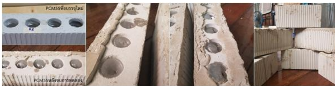
ภาพที่ 51 แสดงลักษณะของผนังอิฐขาวบรรจุ PCM55 หลังทำการแกะกล่องทดลอง
