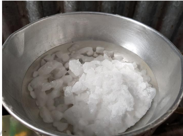
ภาพที่ 15 ละลาย PCMs candle Thailand ด้วยความร้อน
