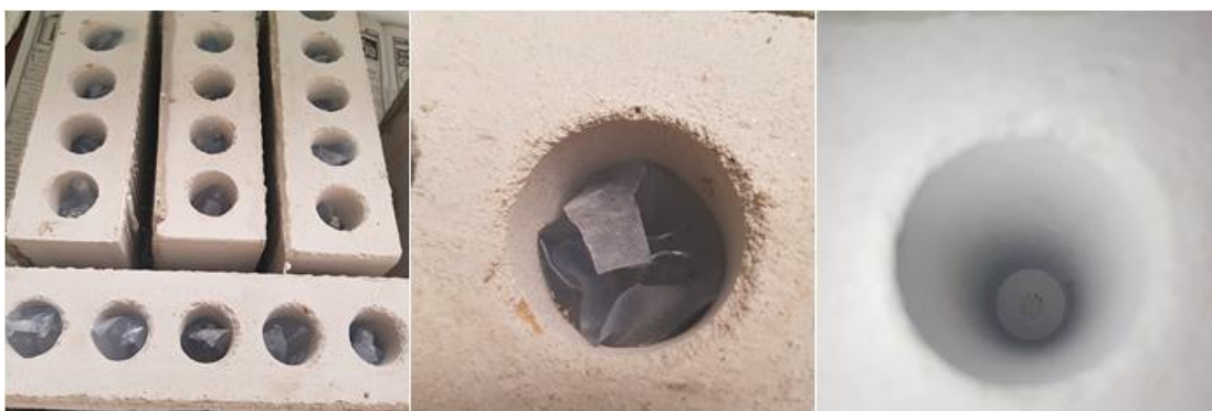
ภาพที่ 57 อิฐขาวที่บรรจุ PCM35 แบบใส่ช่องพลาสติกก่อนบรรจุลงช่องอากาศ
