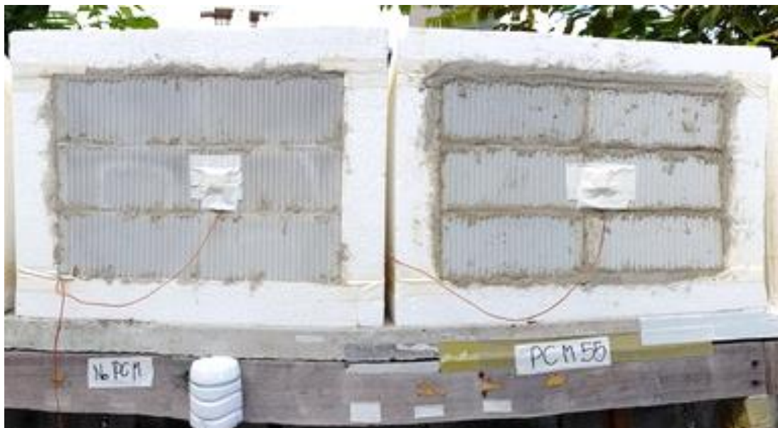
ภาพที่ 31 แสดงกล่องทดลอง ผนังอิฐขาวไม่บรรจุ PCMs และ ผนังอิฐขาวบรรจุPCM 55 วันที่ทำการทดลอง 8 ตุลาคม – 10 ตุลาคม 2560
