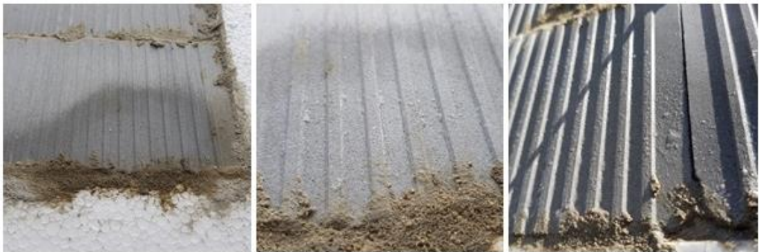
ภาพที่ 42 ภาพขยายแสดงตำแหน่งลักษณะทางกายภาพของผนังอิฐขาวบรรจุ PCM35 ที่เปลี่ยนไป
