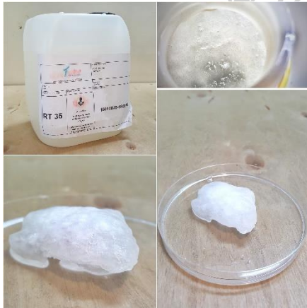
ภาพที่ 13 PCMs ประเภท paraffin wax ของ RUBITHERM® ขนาด 4 ลิตร
