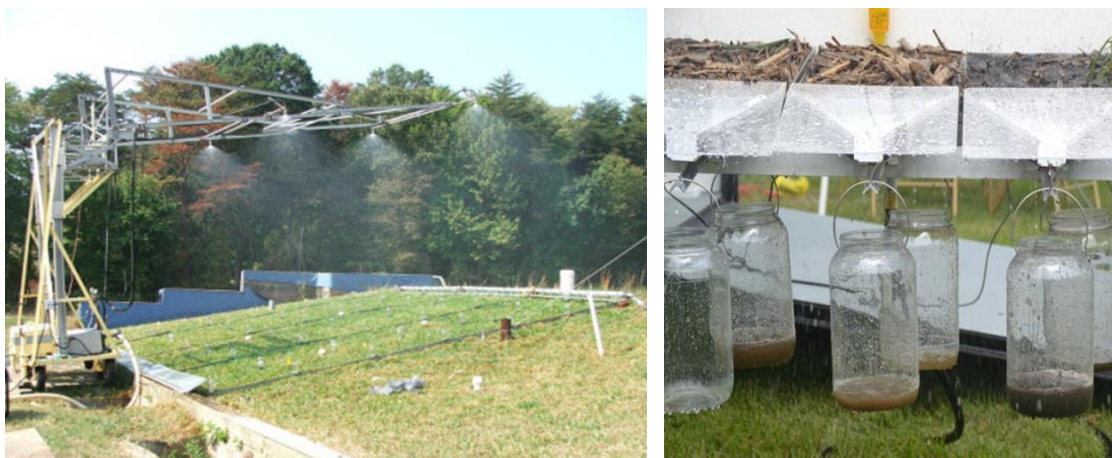
ภาพที่ 17 แสดงตัวอย่างการทำการจำลองฝนตกเทียม (artificial rainfall simulator)
