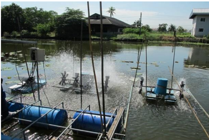
ภาพที่ 45 แสดงระบบกังหันน้ำพลังงานแสงอาทิตย์
