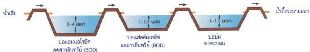
ภาพที่ 11 แสดงระบบบ่อบำบัดน้ำเสีย (แนวตัด)
