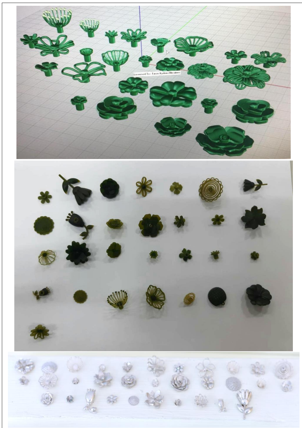
ภาพที่ 38 ขั้นตอนการผลิตดอกไม้สำหรับติดตกแต่งผ้า
