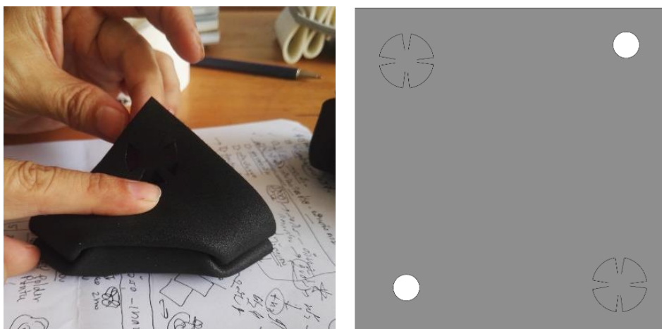
ภาพที่ 66 ใช้แผ่นยางพารา 1 แผ่น พับและพลิกตัวแผ่นยางพาราทำให้เกิดที่นั่งและพนักผิง โดยมี ตัวล๊อคจากเดือยที่ฉลุจากแผ่นยางพารา ที่มา : จากผู้วิจัย
