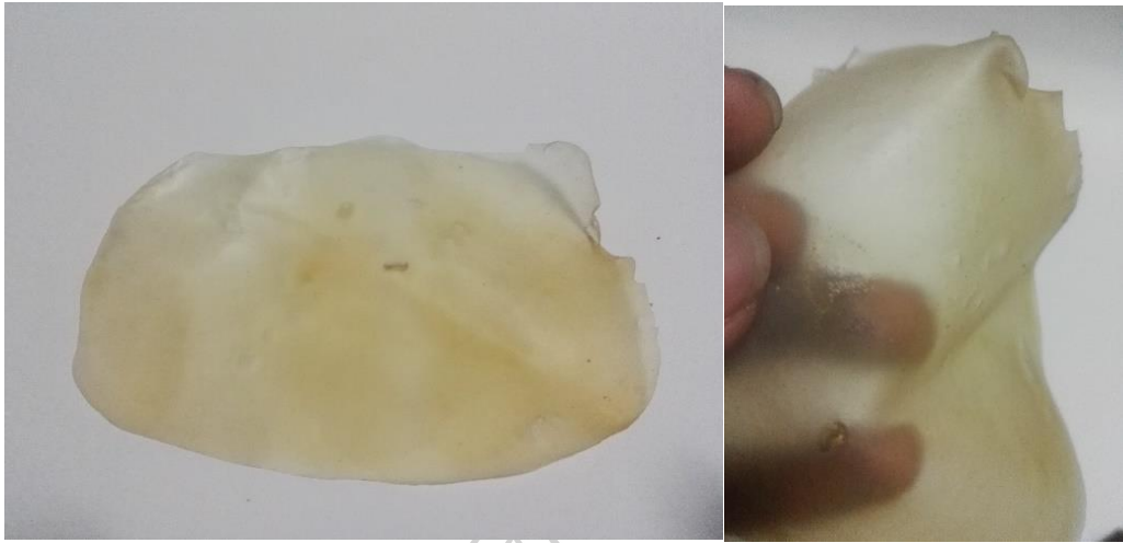
ภาพที่ 50 ชิ้นผิวที่มีลักษณะไม่เรียบเกิดจากแอลกอฮอล์ที่ทำปฏิกิริยากับน้ำยางพารา ที่มา : จากผู้วิจัย
