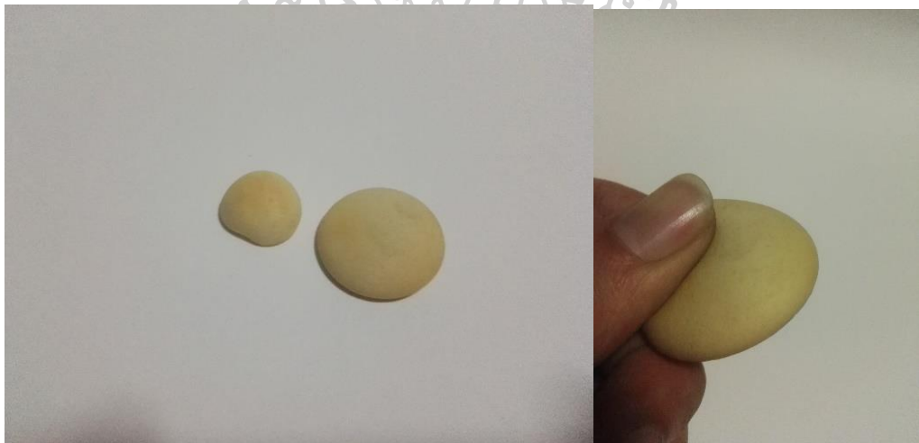
ภาพที่ 53 พื้นผิวที่มีลักษณะเป็นฟองละเอียด จากการตีน้ำยาราดด้วยเครื่องตีและอบด้วย ไมโครเวฟ ที่มา : จากผู้วิจัย
