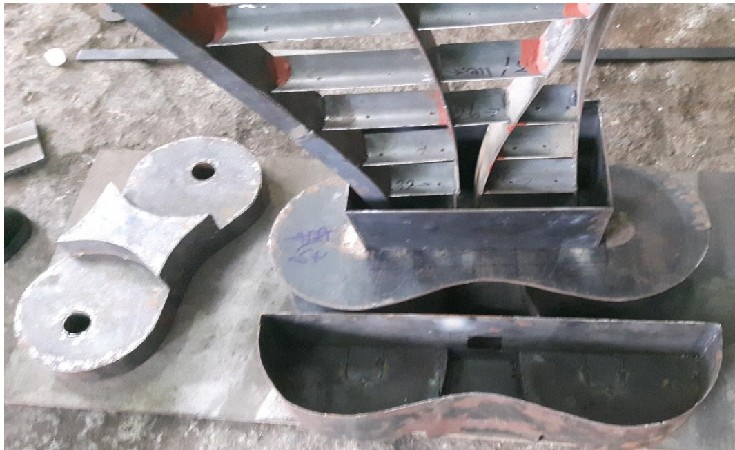
ภาพประกอบ การขึ้นรูปส่วนฐานและส่วนของระบบใส่น้ำ
