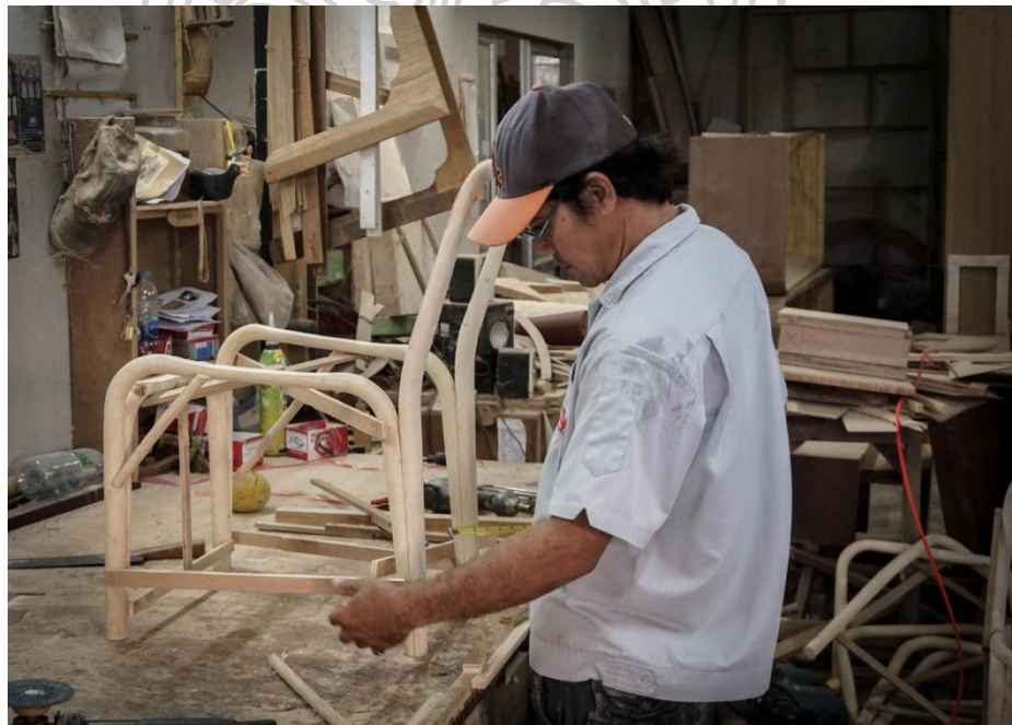
การขึ้นรูปตัวโครงสร้างหลักจากหวาย โดยช่างโครงหวายและไม้
