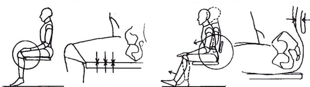
ภาพที่ 32 แสดงตำแหน่งแรงกดทับของการนั่งบนเก้าอี้ที่สูงและต่ำเกินไป ความสูงของที่นั่งควรออกแบบให้สูงพอเหมาะกับสรีระร่างกายมนุษย์ ที่มา: (วรรณิภัก สหสมโชค, 2549q)
