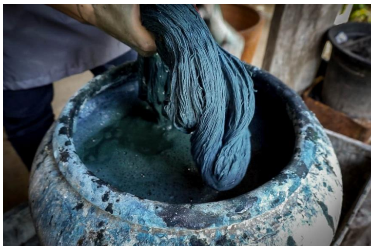
ภาพที่ 41 ภาพแสดงการนำใยกล้วยชงย้อมครามลงในน้ำย้อม ที่มา: ภาพถ่ายโดย นายเฉลิมพงศ์ อ่อนยong วันที่ 12 พฤษภาคม 2561
