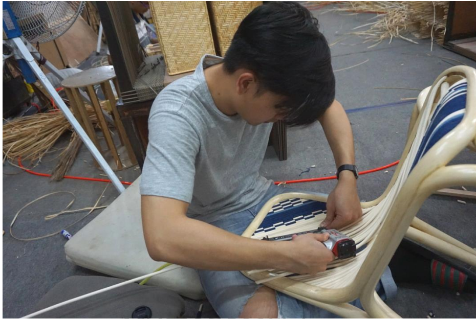
การวางลายบริเวณช่วงที่นั่งและพนักพิง โดยใช้เส้นด้ายใยกล้วยชงย้อมครามพันหวายเส้นเล็ก ขนาด 7 มิลลิเมตร
