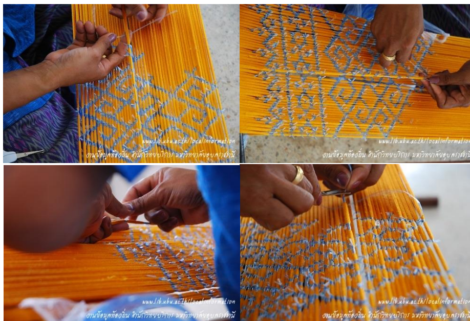
ภาพที่ 35 ภาพแสดงวิธีการมัดหมี พันเชือกให้แน่นตามลวดลาย ไม่ให้น้ำย้อมสีซึมเข้าได้ ที่มา: (บุญชู & นันทวรรณ รักพงษ์, 2555)
