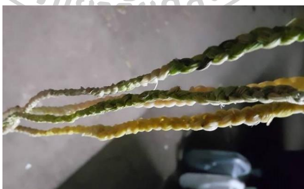
ภาพที่ 41: เส้นใยที่ได้จากการถักจากข้าวโพดโดยวิธีพรมน้ำ ที่มา: พุทธประภา ประชาโชติ ถ่ายภาพเมื่อวันที่ 10 มกราคม 2561
