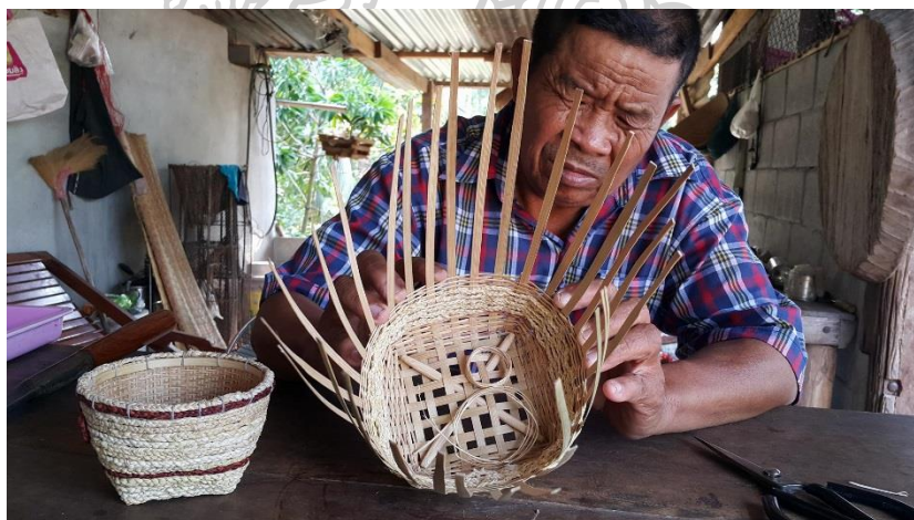
ภาพที่ 57: การขึ้นโครงสร้างของฐานผลิตภัณฑ์ โดยใช้ไม้ไผ่ และหวาย ซึ่งเป็นพืชที่พบในท้องถิ่น ที่มา: พุทธประภา ประชาโชติ ถ่ายภาพเมื่อ 10 มิถุนายน 2561
