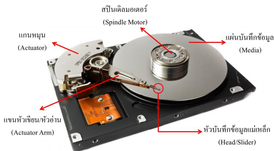
รูปที่ 2.29 ส่วนประกอบของฮาร์ดดิสก์ไครฟ์
