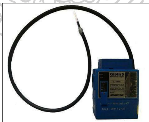
รูปที่ 26 อุปกรณ์การเก็บตัวอย่างสารกลุ่ม BTEX
