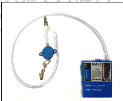
รูปที่ 25 อุปกรณ์การเก็บตัวอย่างฝุ่น PM_{2.5}
