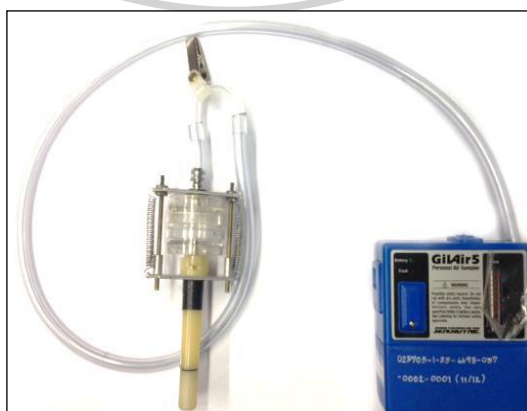
รูปที่ 23 อุปกรณ์การเก็บตัวอย่างฝุ่น PM 10
