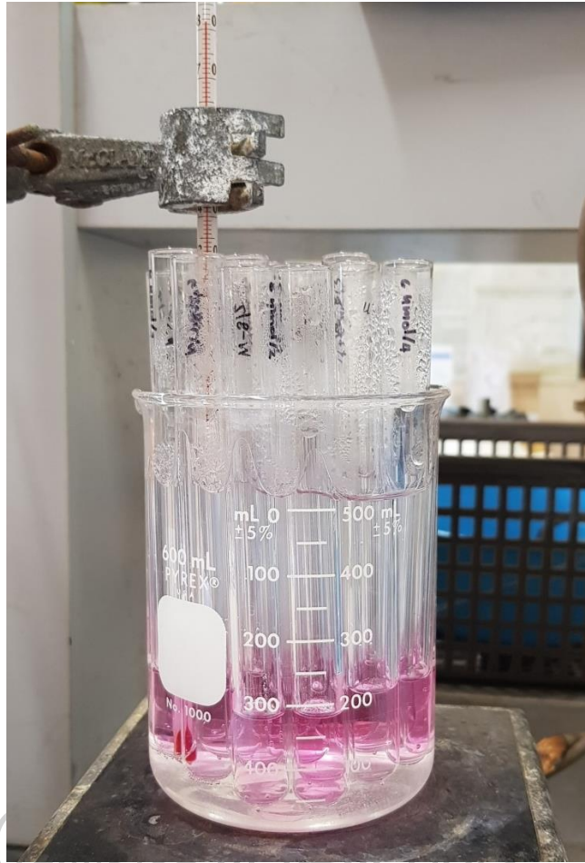
ภาพที่ 18 การให้ความร้อนสารละลายมาตรฐานมาลอนไดอัลดีไฮด์ที่อุณหภูมิ 80 °C
