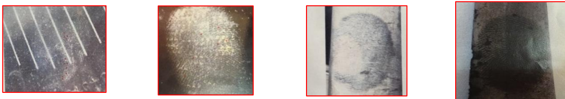
(a) (b) (c) (d) ภาพที่ 18 รอยลายนิ้วมือแฝงที่แช่อยู่ในน้ำประปานครบ 14 วัน ภายหลังจากตรวจเก็บด้วยวิธีชุบเปอร์กลู ( a ) ฝาครอบไฟหน้ารถยนต์ ( b ) กระจกมองข้างรถยนต์ ( c ) ที่จับเปิด-ปิดประตูรถยนต์ ( d ) อวูร์มิต
