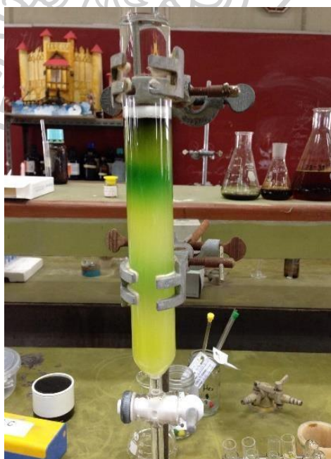
ภาพที่ 16 การแยกสารด้วยวิธี column chromatography
