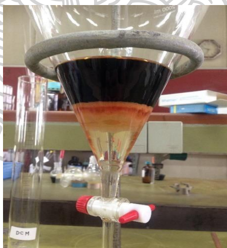
ภาพที่ 14 การเกิด emulsion เมื่อเติมเบสมากเกินไป
