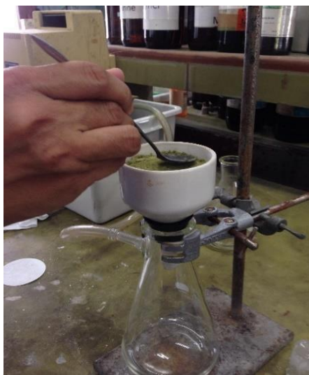
ภาพที่ 17 การบรรจุ silica gel plate และใบกระท่อมลงใน buchner funnel
