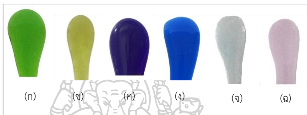
รูปที่ 4.1 แก้วสีในสถานะออกซิไดซ์ (ก) Cr-glass (ข) Fe-glass (ค) Co-glass (ง) Cu-glass (จ) Nd-glass (ฉ) Er-glass
