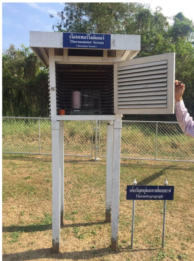
รูปที่ 3.3 เครื่องวัดอุณหภูมิและความชื้นสัมพัทธ์แบบกราฟ ที่สถานีอุตุนิยมวิทยาบางนา กรุงเทพฯ
