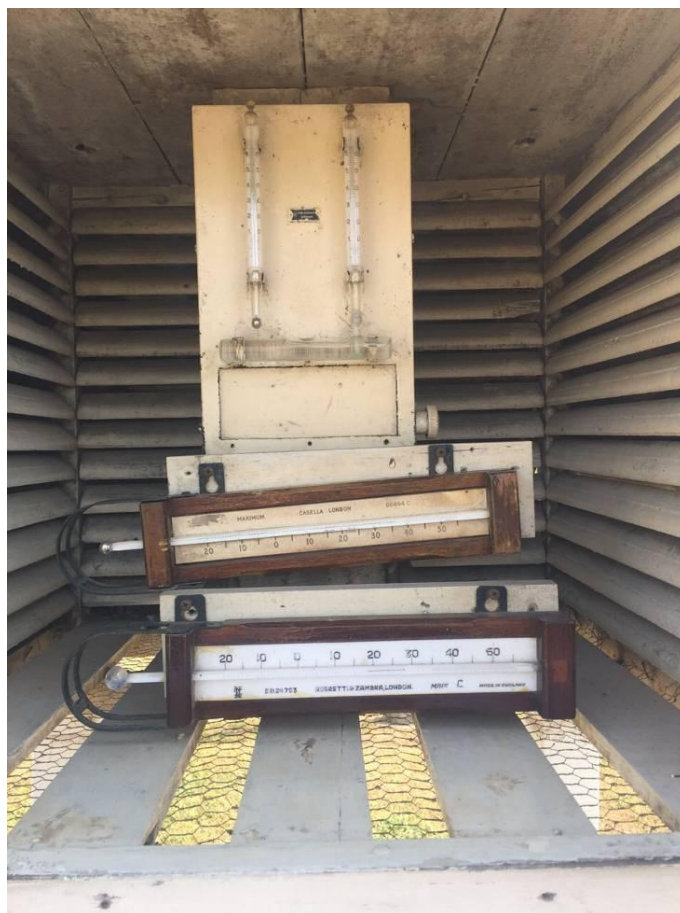
รูปที่ 3.2 เครื่องไฮโครมิเตอร์กระเปาะเปียกและกระเปาะแห้ง ที่สถานีอุตุนิยมวิทยาบางนา กรุงเทพฯ
