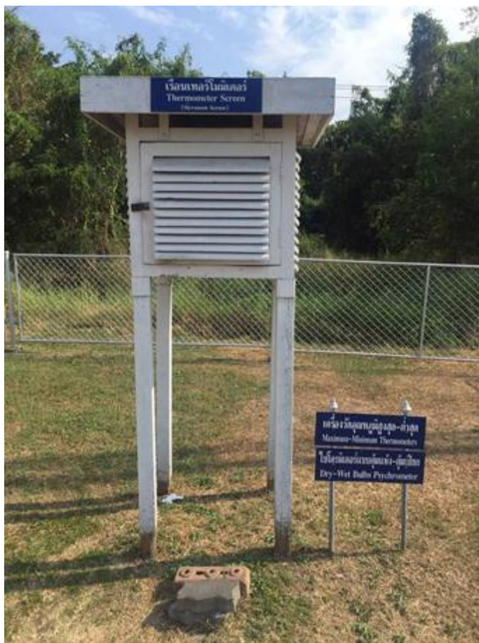
รูปที่ 3.1 เรือนเทอร์โมมิเตอร์ที่สถานีอุตุนิยมวิทยาบางนา กรุงเทพฯ
