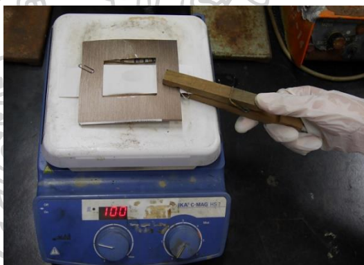
ภาพที่ 3.2 การนำตัวอย่างกระดาษ Thermal ที่ประทับลายนิ้วมือแล้วมาอังบน hot plate
