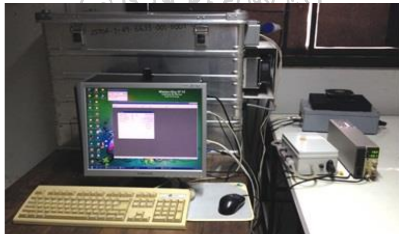
รูปที่ 3.2 เครื่องวัดสเปกตรัมรังสีอัลตราไวโอเล็ตของ Bentham ที่ติดตั้งที่มหาวิทยาลัยศิลปากร
