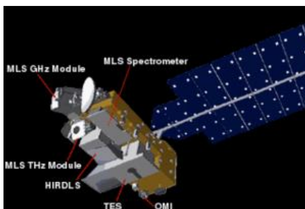
รูปที่ 3.13 การติดตั้งเครื่องมือ OMI บนดาวเทียม AURA
