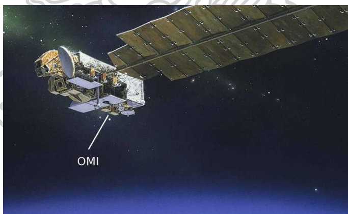
รูปที่ 2.6 เครื่องมือ OMI ที่ติดตั้งอยู่บนดาวเทียม Aura
