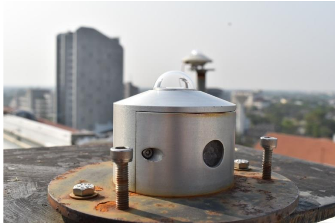
รูปที่ 3.1 หัวรับรังสีของเครื่องวัดสเปกตรัมรังสีอัลตราไวโอเล็ตที่ติดตั้งบนอาคาร วิทยาศาสตร์ มหาวิทยาลัยศิลปากร
