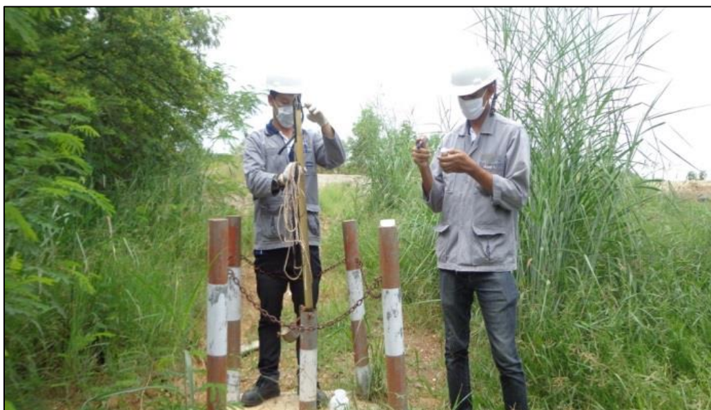
รูปที่ 3.14 การเก็บตัวอย่างน้ำใต้ดินด้วยวิธี Bailer Sampling
