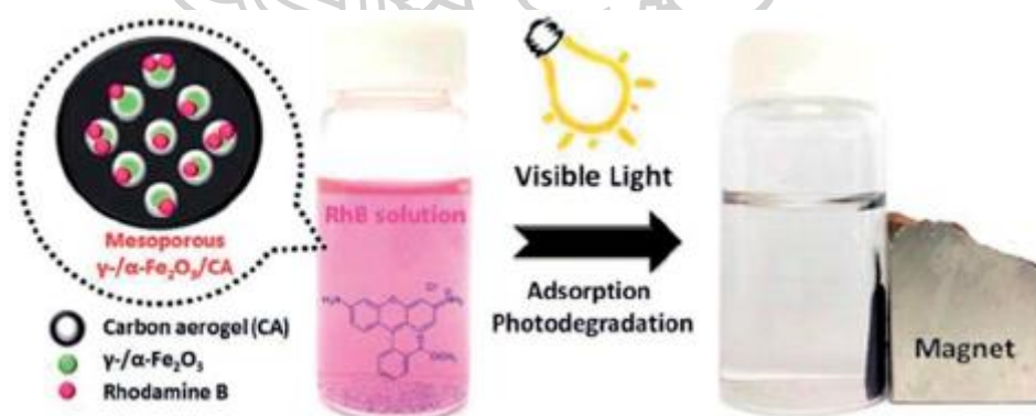
รูปที่ 7 การกำจัดสีย้อม RhB ด้วย \gamma - \text{Fe}_2\text{O}_3/\alpha - \text{Fe}_2\text{O}_3/\text{CA} ภายใต้แสงขาว
