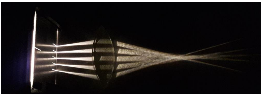
ภาพที่ 12 การทำงานของเลนส์นูน
