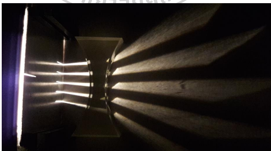
ภาพที่ 13 การทำงานของเลนส์เว้า
