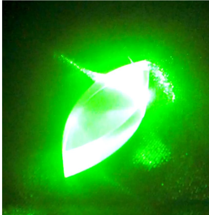
ภาพที่ 62 การสะท้อนกลับภายในเลนส์ (Total Reflection)
