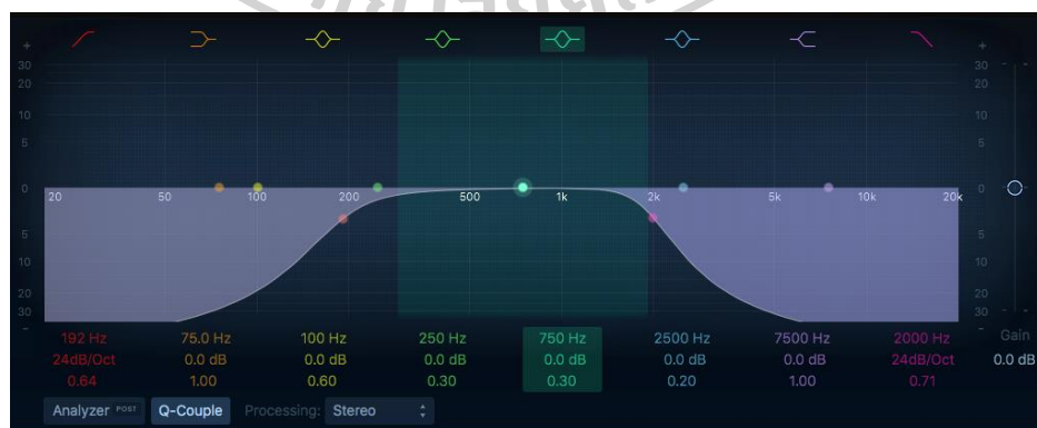
ภาพที่ 36 การใช้ไฮพาสและโลว์พาสฟิลเตอร์
