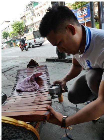
รูปที่ 16 : การแสดงภาพการตัดตะกั่วและเจียไม้ออกบางส่วนเพื่อเทียบเสียง
