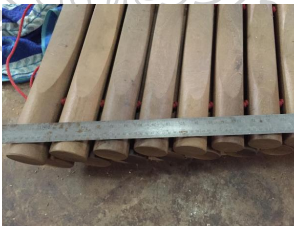
รูปที่ 17 : ภาพการหลังจากการเจียไม้ปลายลูกและเจียส่วนท้องโปงลางออกเพื่อเทียบเสียง
