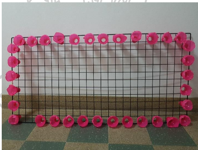
ภาพที่ 92 นำคอขวดที่ลนไฟแล้วนำมาผูกติดกับตะแกรงให้เต็มบริเวณแผ่นตะแกรง โดยใช้เส้นเอ็น
