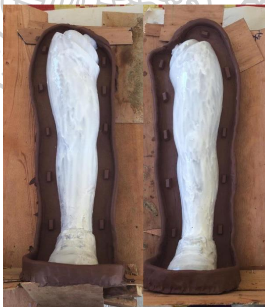
ภาพประกอบที่ 33 ภาพขั้นตอนการแบ่งครึ่งแม่พิมพ์
