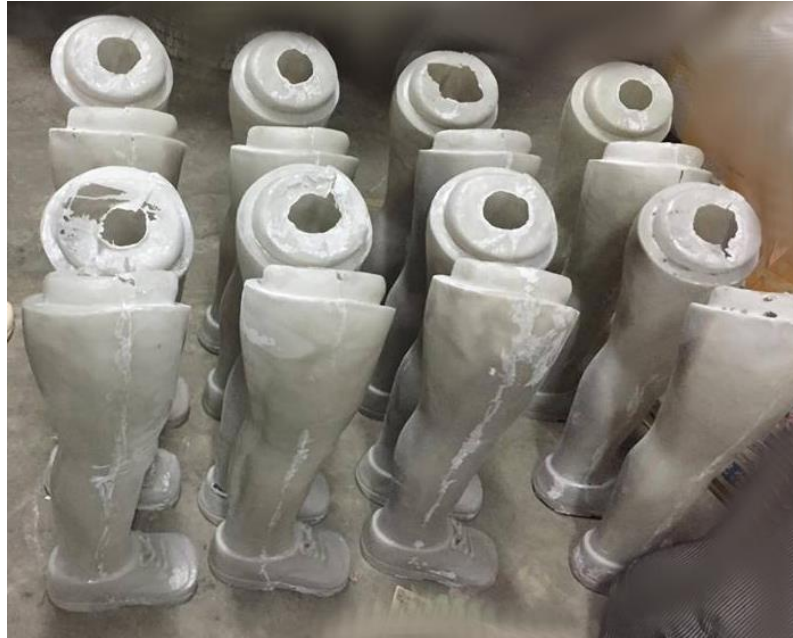
ภาพประกอบที่ 36 ภาพขั้นตอนการหล่อขาด้วยเรซิน
