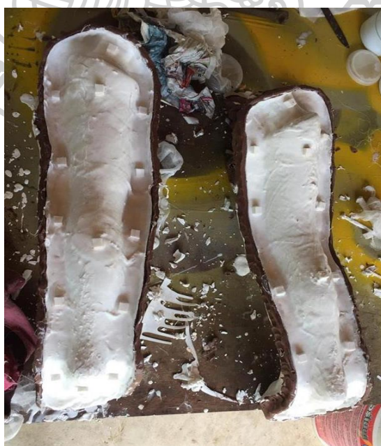
ภาพประกอบที่ 35 ภาพขั้นตอนการทำแม่พิมพ์ส่วนหลัง
