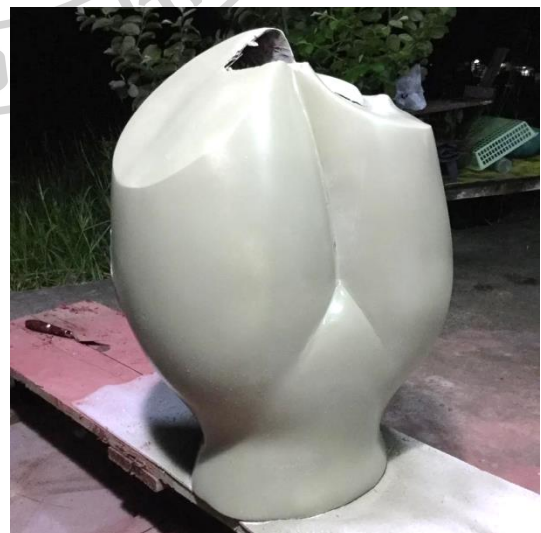
ภาพที่ 31 ภาพการขัดผิวชิ้นงานเพื่อการทำสี
