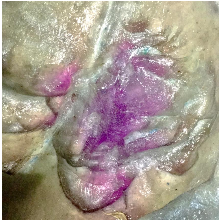
ภาพที่ 29 ภาพการซับใยแก้วเพื่อความแข็งแรงและน้ำหนักเบาของชิ้นงาน
