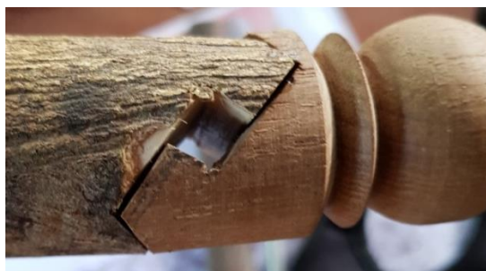
ภาพที่ 69 ช่องว่างสำหรับใส่สลัก
