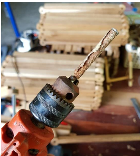
ภาพที่ 110 ใช้กระดาษพันกับตะปู ทำเป็นดอกสว่าน เพื่อใช้ในการขัด
