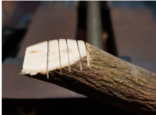
ภาพที่ 67 การใช้เลื่อยบั้งบริเวณร่องเดือย
