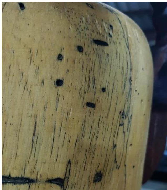
ภาพที่ 211 พื้นผิวของไม้ขนุน และร่องรอยที่เกิดจากการกรงไม้
