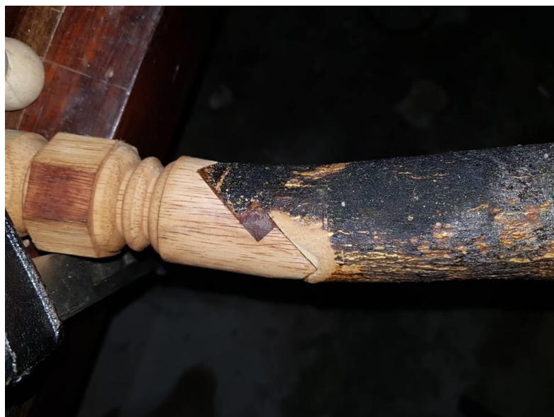
ภาพที่ 217 การเข้าไม้แบบสลักเดือยที่มีความเรียบร้อยมากขึ้น
