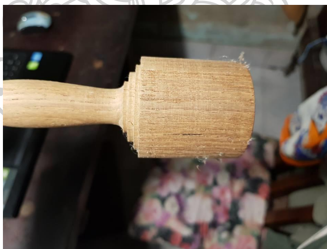
ภาพที่ 214 ตัวอย่างการใช้เทคนิคการกลึงไม้เพื่อเลียนแบบค้อนแกะสลักไม้ ในผลงาน “เครื่องมือ 3”
