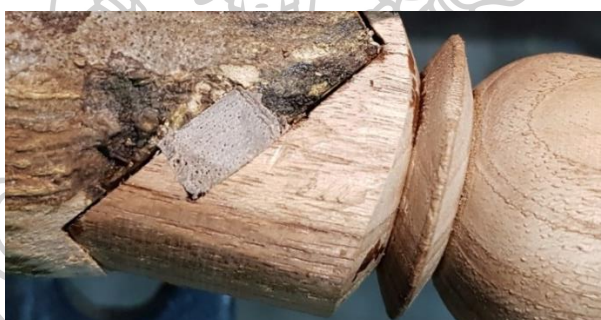
ภาพที่ 71 การเข้าไม้แบบสลักเดือยที่เสร็จสมบูรณ์
