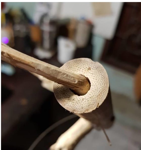
ภาพที่ 213 การประกอบไม้โดยใช้เดือยแบบง่าย ในผลงาน “เครื่องมือ 2”
