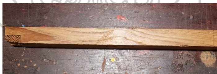
ภาพที่ 105 ไม้ที่ร่างแบบแล้ว (ด้านข้าง)
