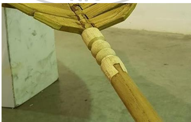
ภาพที่ 72 การเข้าไม้แบบเดือยหางเหยี่ยว
