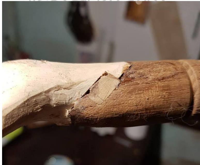
ภาพที่ 216 การประกอบไม้ด้วยการเข้าไม้แบบสลักเดือย ในผลงาน “เครื่องมือ 3-เครื่องมือ 5”
