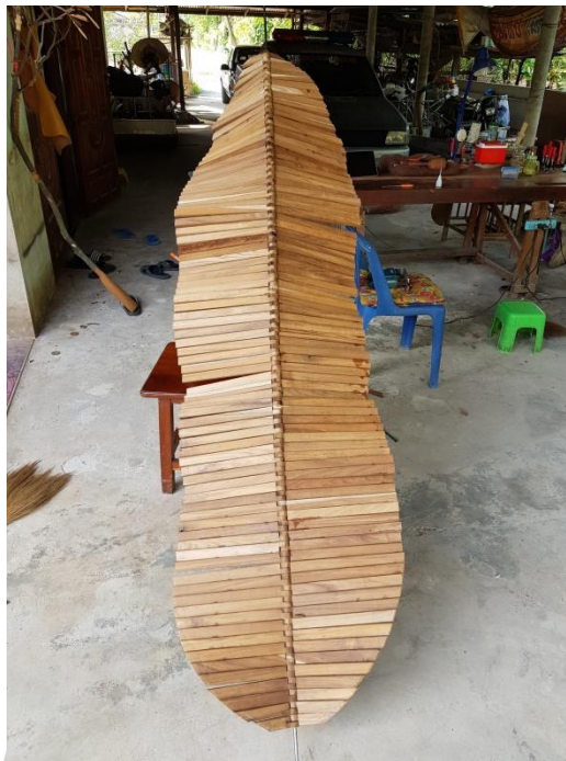
ภาพที่ 112 ชิ้นงานที่ตัดขอบแล้ว
