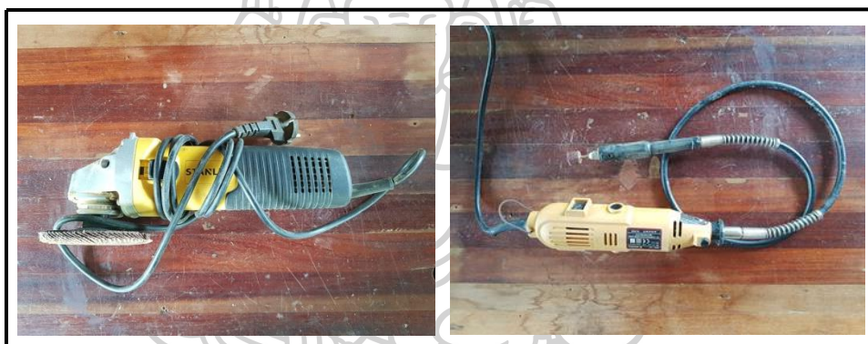
ภาพที่ 57 เครื่องเจียร, เครื่องเจียรสายอ่อน
