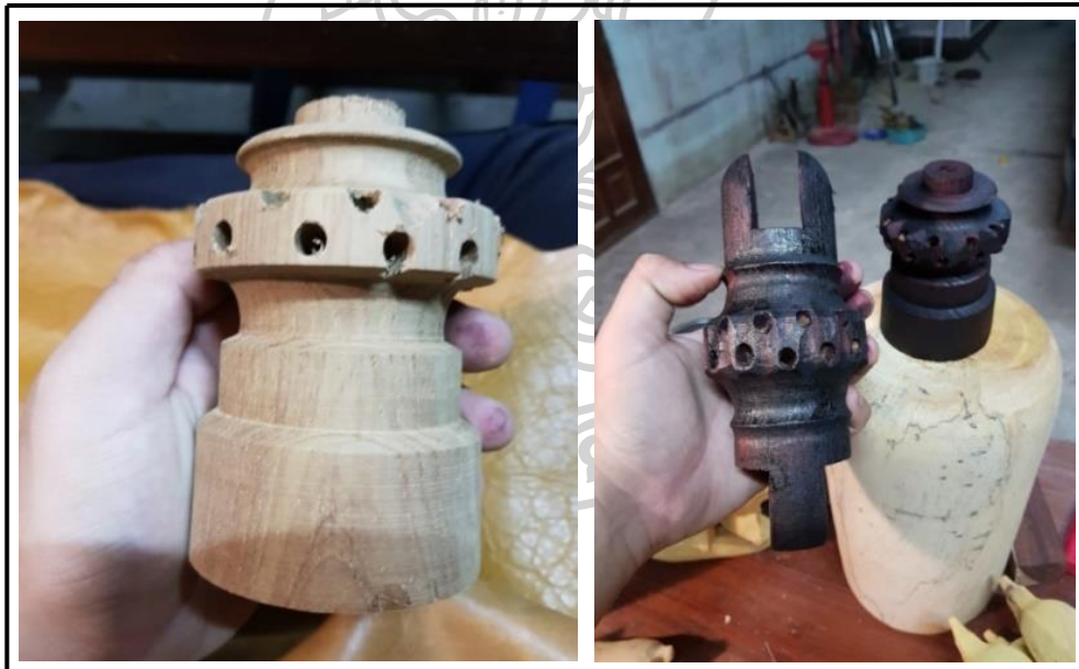
ภาพที่ 123 เจาะรูและขัดไม้เตรียมประกอบ
