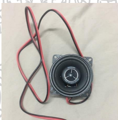
ภาพที่ 32 ภาพลำโพงขนาดเส้นผ่านศูนย์กลาง 4 นิ้ว
