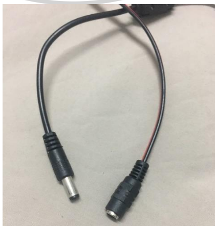
ภาพที่ 36 ภาพขั้วต่อสายไฟ ที่ต่อจากหม้อแปลงไฟฟ้า
