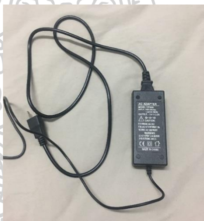
ภาพที่ 35 ภาพหม้อแปลงไฟสำหรับเครื่องขยายเสียง
