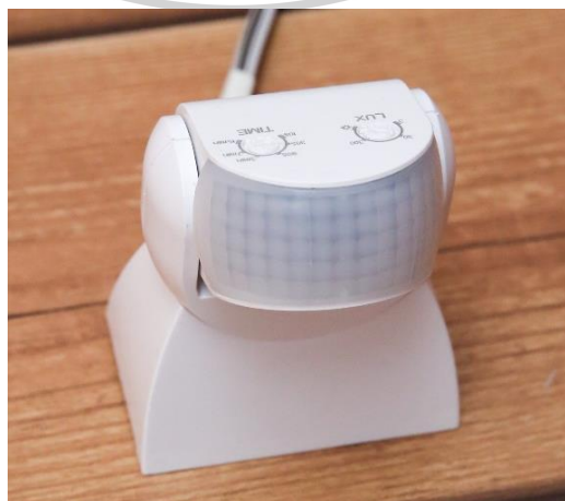
ภาพที่ 39 ภาพเซนเซอร์สวิตช์ไฟแบบจับการเคลื่อนไหว
