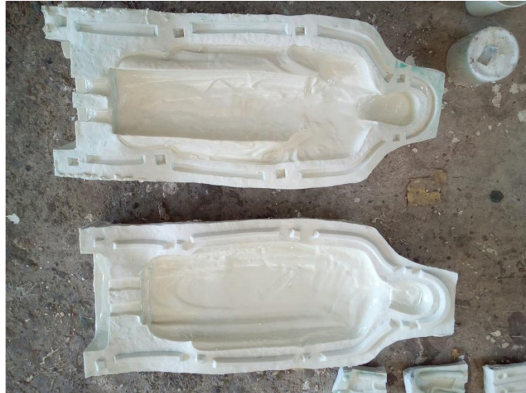
ภาพที่ 64 ทาเรซินลงไปแม่พิมพ์
