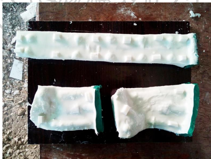
ภาพที่ 44 ตัดของยางชิลิโคนก่อนทำพิมพ์ครอบ
