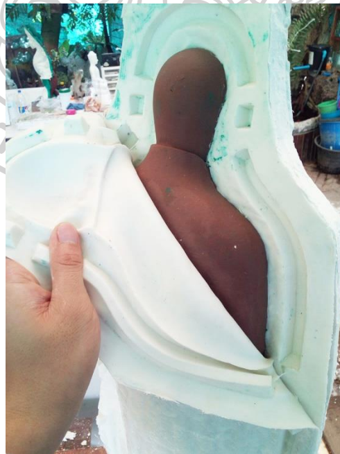
ภาพที่ 59 แกะแม่พิมพ์ยางซิลิโคนออกจากผลงาน
