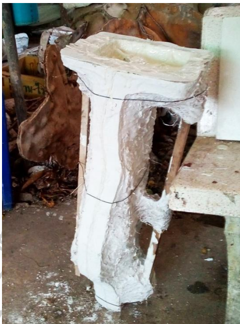
ภาพที่ 68 ประกบพิมพ์ทั้งสองฝั่งเข้าด้วยกัน
