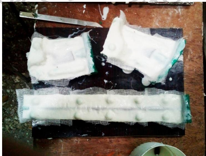
ภาพที่ 53 ปูผ้าก๊อตก่อนลงยางรอบสุดท้าย
