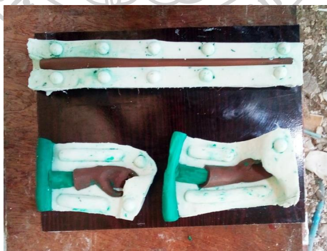
ภาพที่ 50 ทาสบู่อหรือวาสลีนบริเวณขอบของแม่พิมพ์
