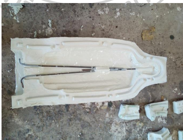
ภาพที่ 67 ใส่โครงสร้างด้วยเหล็ก
