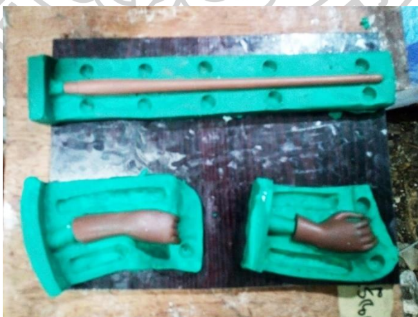
ภาพที่ 38 กั้นแบ่งครึ่งชิ้นส่วนต่าง ๆ ด้วยดินน้ำมัน
