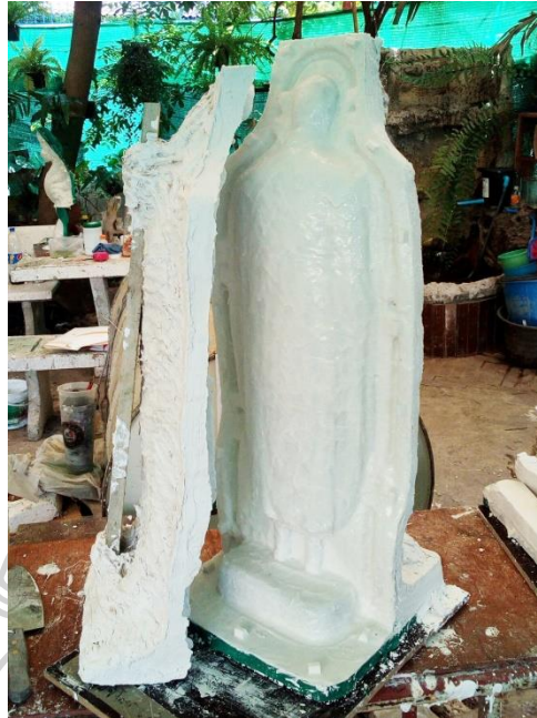
ภาพที่ 58 แกะแม่พิมพ์ครอบออกจากผลงาน
