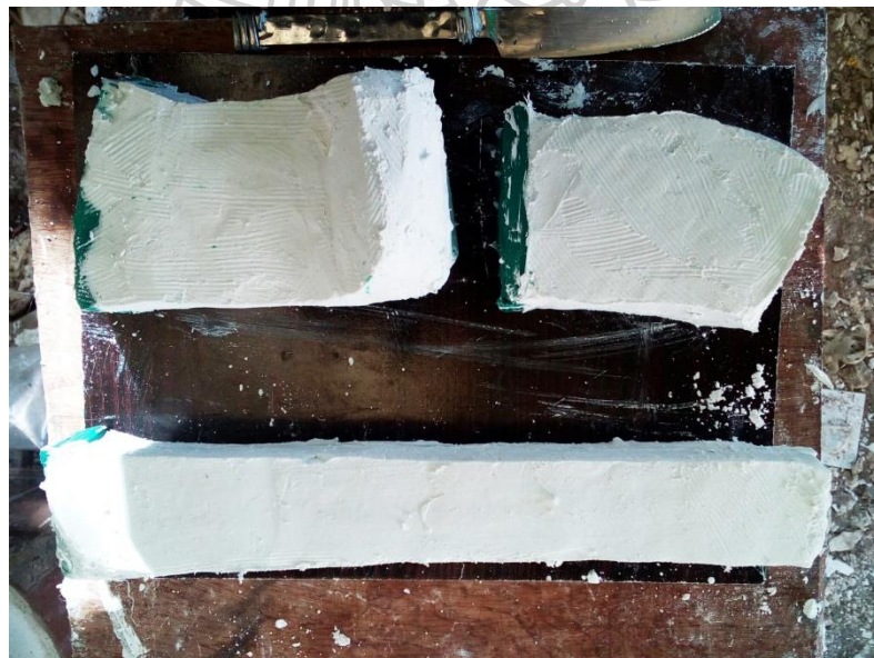
ภาพที่ 46 ตกแต่งขอบแม่พิมพ์ปูนปาสเตอร์
