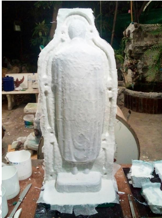
ภาพที่ 52 ทายางรอบสุดท้ายฝั่งด้านหลัง
