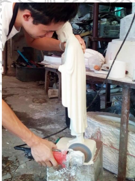
ภาพที่ 71 ขัดแต่งตะเข็บของผลงานด้วยเครื่องเจียร
