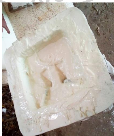
ภาพที่ 69 กรอกเรซินลงในแม่พิมพ์
