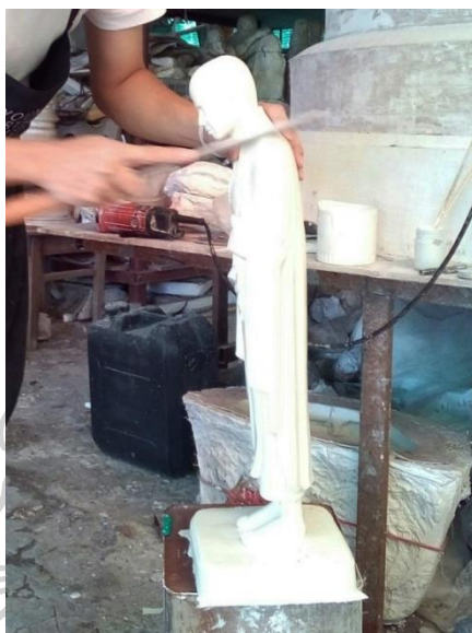
ภาพที่ 70 ขัดแต่งตะเข็บของผลงานด้วยตะไบ
