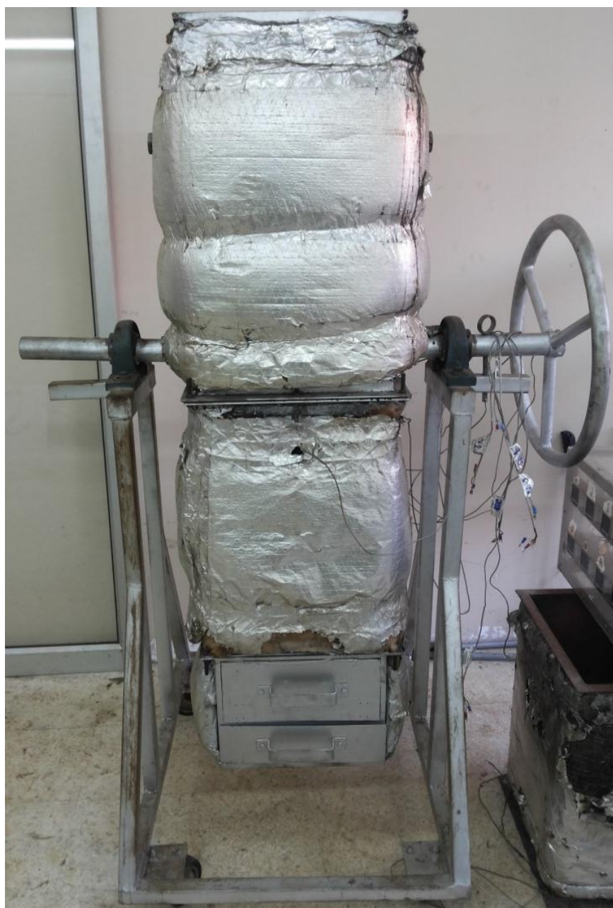
รูปที่ 3.19 แสดงเตาปฏิกรณ์ทอริแฟคชั่นชนิดเทอร์โมไซฟอน
